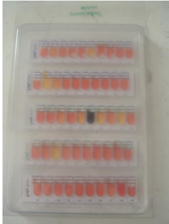
Figura 3.8: Galería de pruebas bioquímicas API 50CH para Bacillus cereus , después de 48 horas de incubación a 35°C (Córdoba, 2008).
