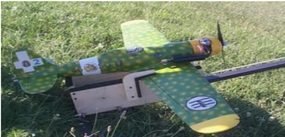
**Figura: 2.11.** Sistema de carga tipo cuna.
