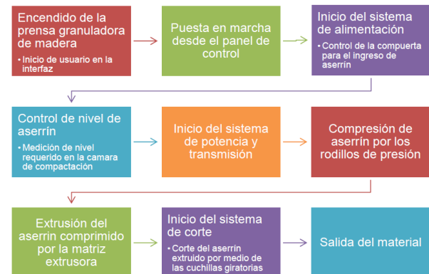
Figura 34 Secuencia de trabajo de la prensa granuladora de madera.
