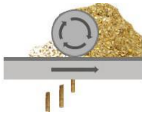
Figura 6 Esquema movimiento rodillo sobre matriz plana.
