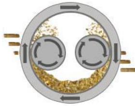
Figura 5 Esquema movimiento rodillo sobre matriz anular.
