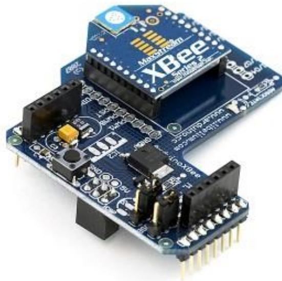
**Fig. 1.11.** Xbee Shield.
