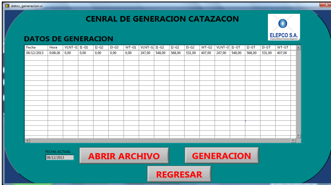
Figura 3. 40: Entorno del SubVI para la selección del tipo de archivo donde se guardan todos los datos de generación.
