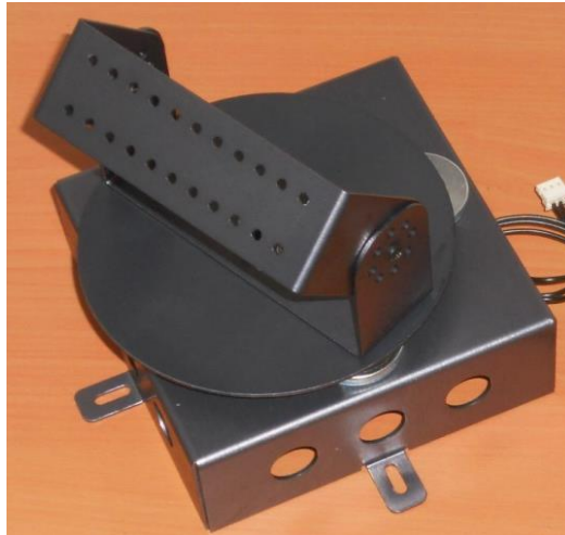
Figura 2.24: Sujeción de la base para los Servomotores 2 y 3.
