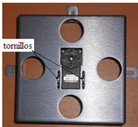
Figura 2.22: Primer servomotor sujeto a la base del servomotor.
