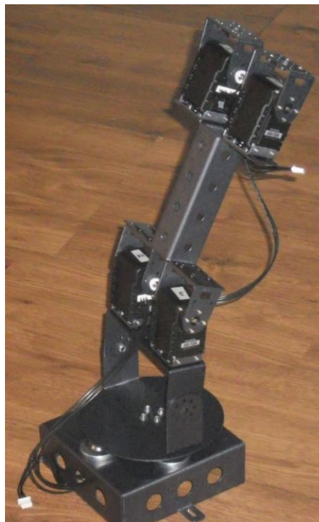
Figura 2.27: Sujeción de los servomotores 4 y 5.
