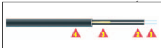
Figura. 2.24. Cable FOP-R Duplex: (1): fibra plástica (2) protección individual (3) refuerzo de aramida (4) cubierta exterior FRLS.
