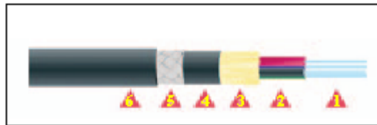
Figura. 2.25. Cable tipo FOS-CDIR-AD: (1) fibra óptica HCS (2) recubrimiento ajustado (3) refuerzo de aramida (4) cubierta interior (5) armadura de trenza de fibra de vidrio (6) cubierta exterior FRLS
