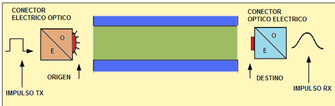
Figura. 2.10. Propagación de impulsos luminosos
