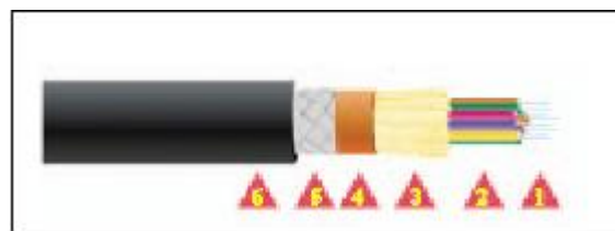
Figura. 2.23. Cable óptico CDAM con protección antirroedores: (1) fibra óptica ( 2) recubrimiento ajustado (3) refuerzos de aramida (4) cubierta interior (5) armadura de trenza de hilos de acero (6) cubierta exterior LSZH.
