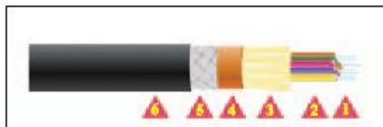
Figura. 2.26. Cable tipo CDAD: (1) fibra óptica (2) recubrimiento ajustado (3) refuerzo de Aramida (4) cubierta interior (5) armadura de trenza de fibra de vidrio (6) cubierta exterior LSZH
