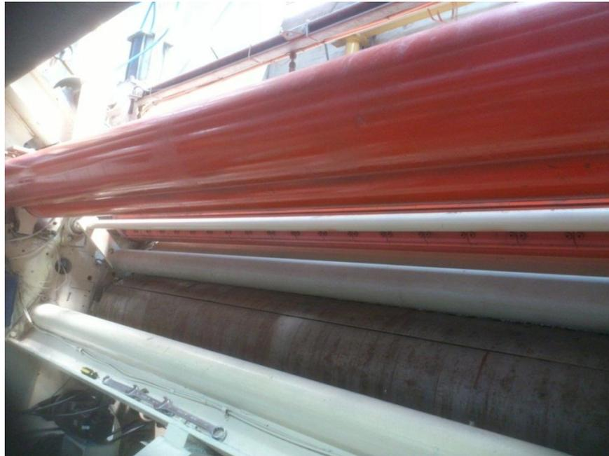
**Figura 4.19 Rodillo dedroll (corte de fin de rollo)**
