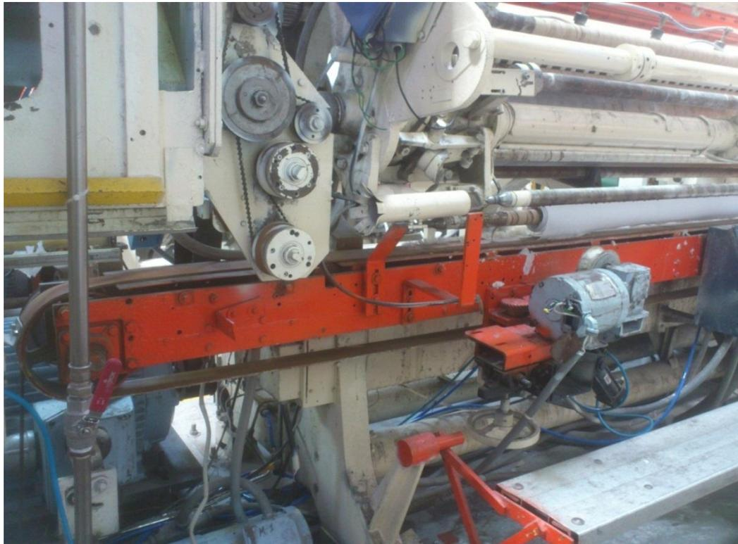
**Figura 4.23 Ingreso de nuevo core y salida de rollo terminado**
