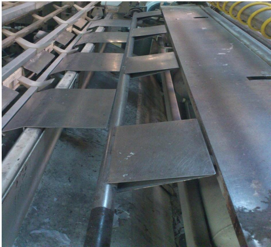
**Figura 4.26 Accionamiento desvío de rollo no sellado**
