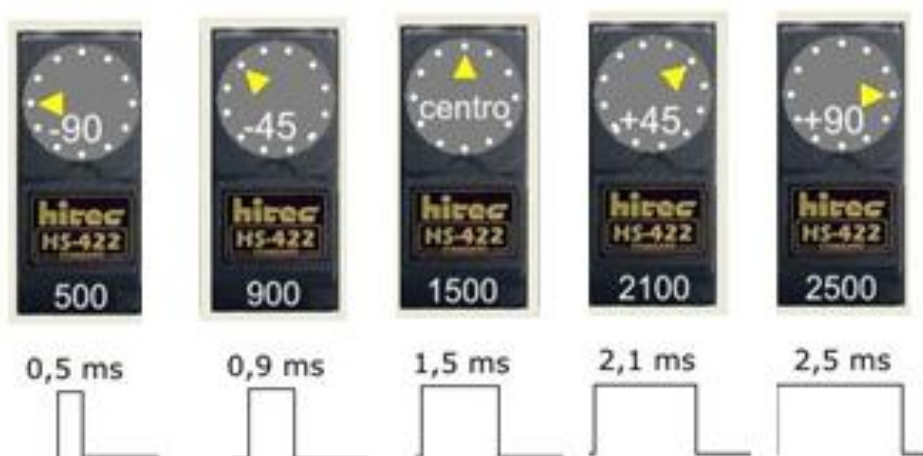
Fig. 92 Tiempos de respuesta de un servomotor
