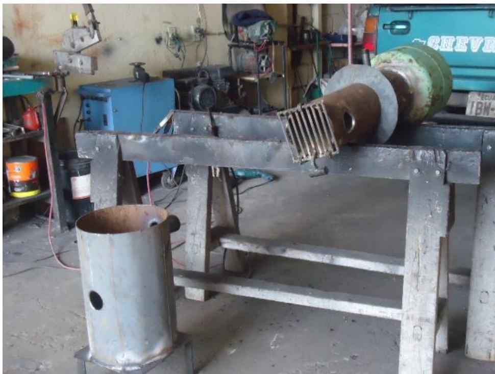
Fig. 133 Acople final del reactor
