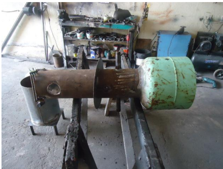
Fig. 129 Zona de reducción acoplada a la tolva
