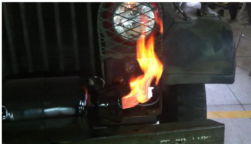
Fig. 150 Salida de gas producido por biomasa.
