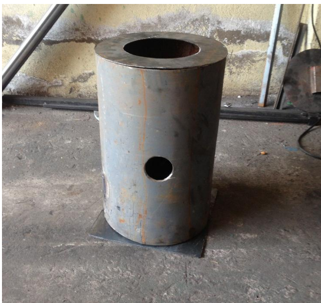
Fig. 72 Acumulador primario de Gas
