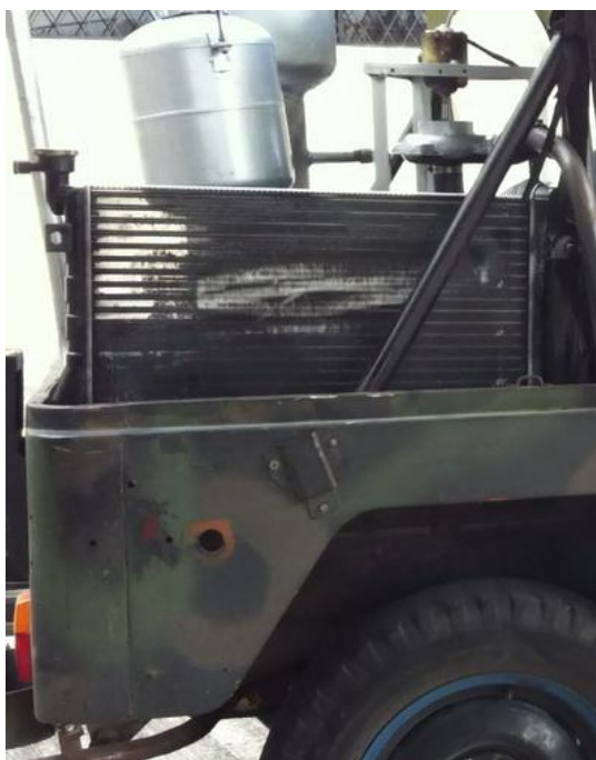
Fig. 140 Ubicación de enfriador.
