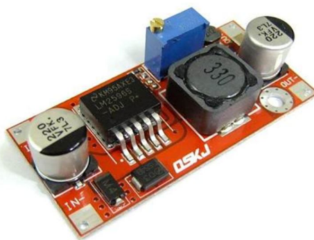
Figura 5.7 Módulo regulador de voltaje
