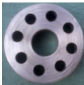
Figura 3.38 Limitador de flujo
