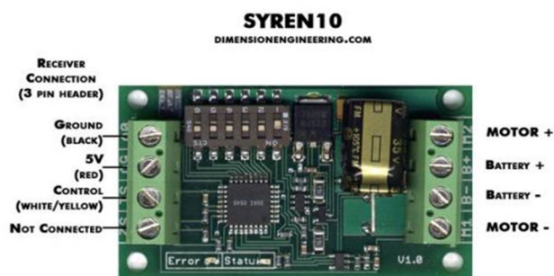
Figura 5.8 Tarjeta de control de voltaje
