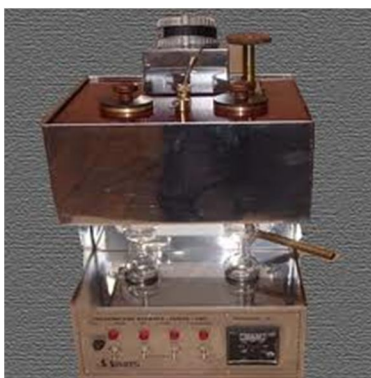
Figura 3.16 Viscosímetro de Saybolt
