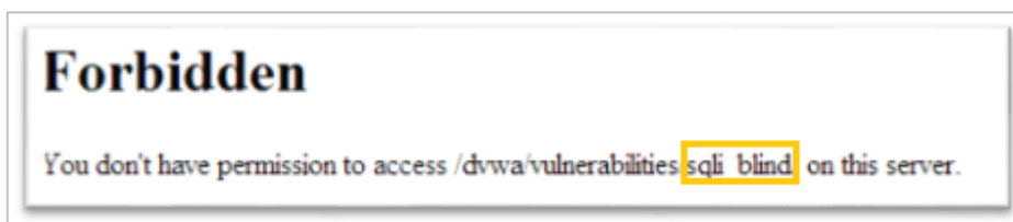
Figura. 5.24. Bloqueo de ModSecurity a ataque SQL Injection Blind
