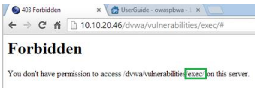
Figura. 5.35. Bloqueo de ModSecurity a ataque de Ejecución de Código
