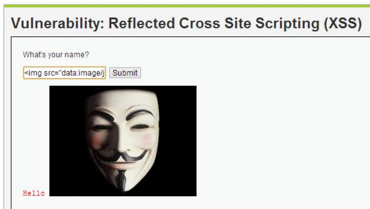
Figura. 5.29. Ejecución de Vulnerabilidad de Cross Site Scripting Reflejada
