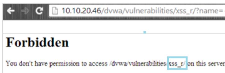
Figura. 5.30. Bloqueo de ModSecurity a ataque XSS Reflejado
