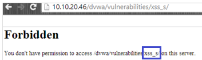
Figura. 5.31. Bloqueo de ModSecurity a ataque XSS Almacenado
