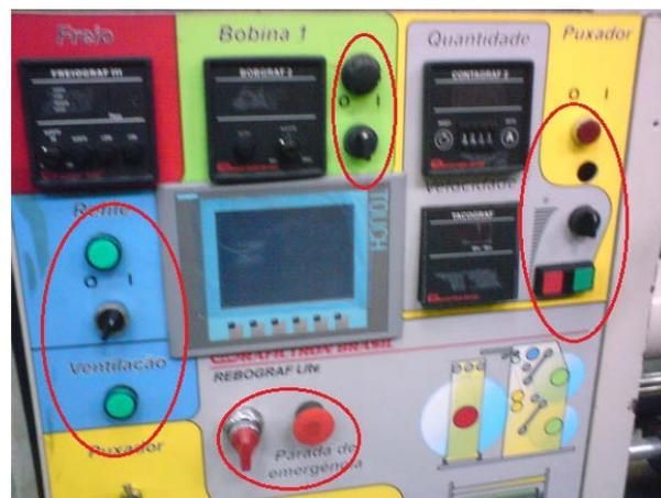
**Figura3. 12** Elementos de maniobra y control
