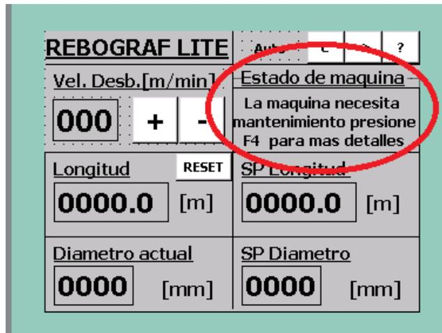
**Figura3. 30** Pantalla de supervisión con problemas de mantenimiento
