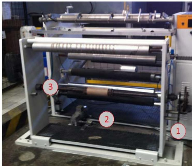
**Figura3. 5** Cuerpo de desbobinado readecuado
