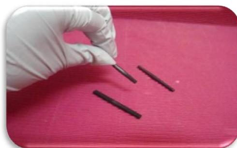
**Figura 3.11** Electrodeposición de plata en el electrodo de grafito (Anrango, 2009).
