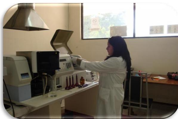
**Figura 2.4** Medición de plata en el Espectrofotómetro de AA (Anrango, 2009).
