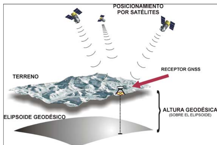
Figura. 2.3 Altura elipsoidal de un punto sobre el terreno Fuente: www.inegi.gob.mx
