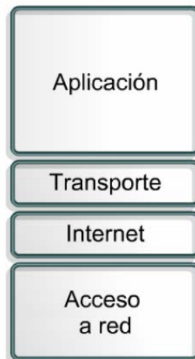
Figura 2.9: Capas del Modelo TCP/IP.
