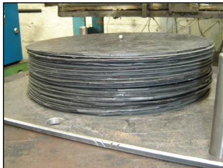
Figura 27 Composición de la estructura interna del aislador.
