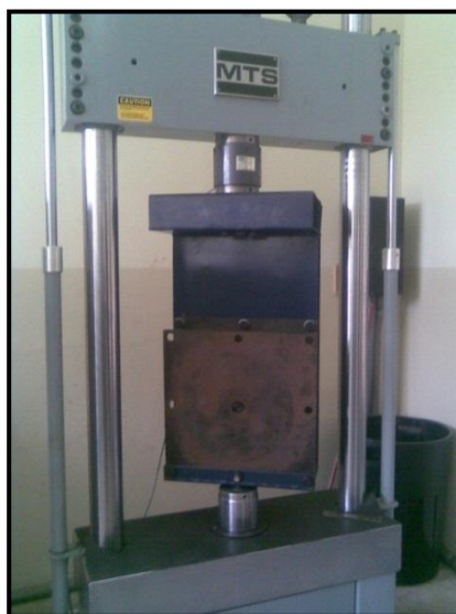
Figura 18 Acople y Aislador elastomérico montados en la Máquina de Ensayos Universales.
