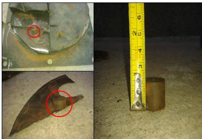
Figura 24 Varilla utilizada como separador entre las láminas de refuerzo 1 y 2.
