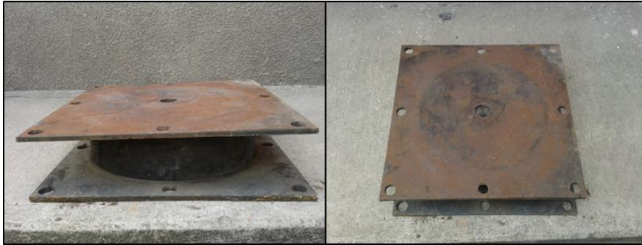
Figura 17 Aislador elastomérico proporcionado por ANDEC antes de ser Ensayado
