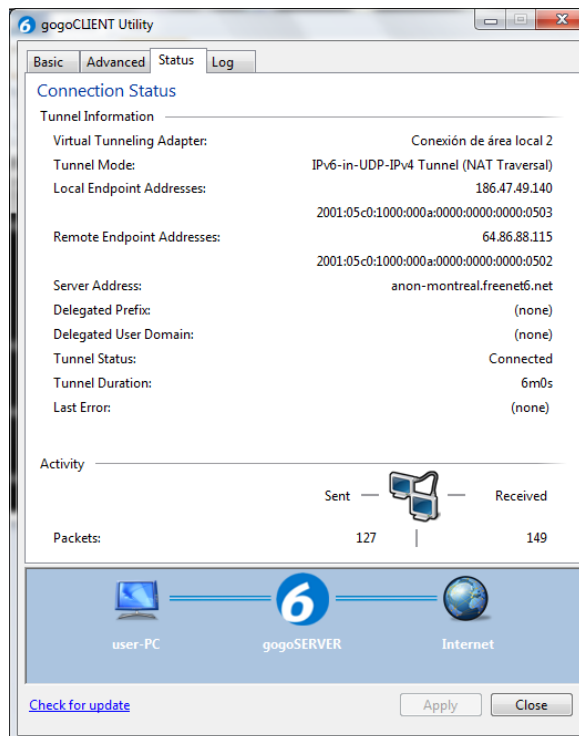
Figura 83. Status de conexión de gogoClient.
