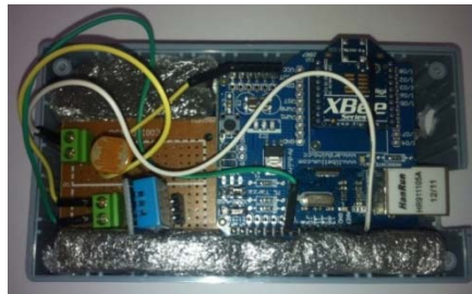
Figura 32. Integración placa de sensores con el nodo coordinador.
