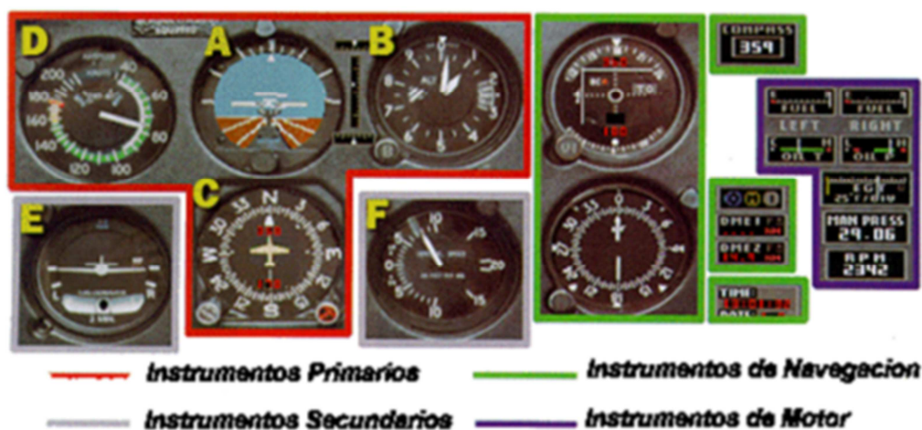
Figura 2.15. Instrumentos de vuelo (se definen las categorías por líneas de colores) (García de la Cuesta, 2009)
