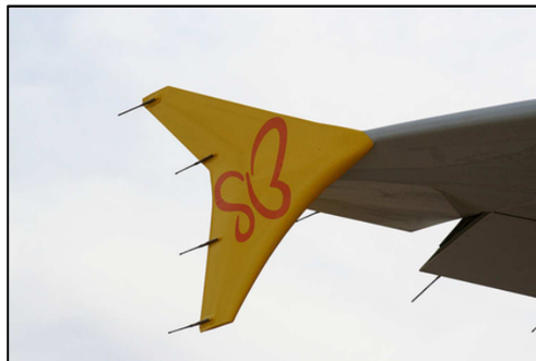
Figura 6.20 Cables descarga estática en un avión (Whelen Engineering Co.)
