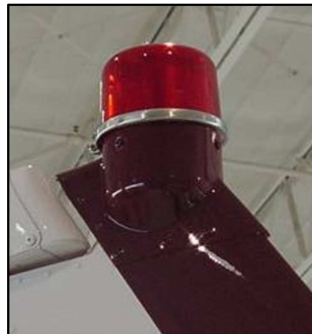
Figura 6.3 Luces de BEACOME ubicado estabilizador vertical ( Whelen Engineering Co. )
