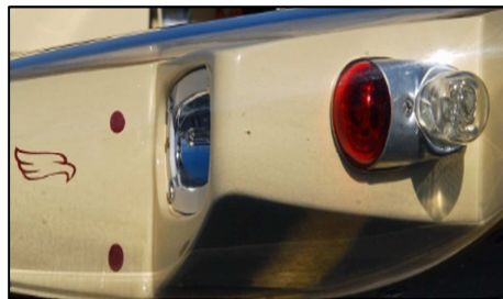
Figura 6.2 Luces de STROBE en el WINTIP a la izquierda ( Whelen Engineering Co. )
