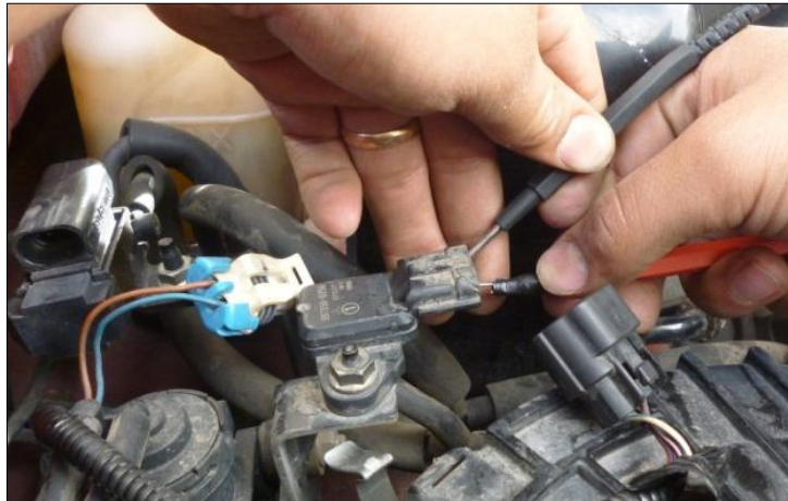
Figura 5.6: Método de medición de la resistencia del MAP.
