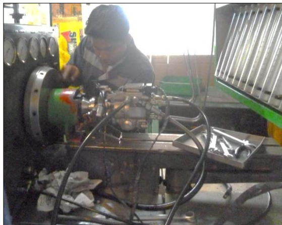
Figura 8.1: Montaje de la bomba VP44 al banco de pruebas universal.
