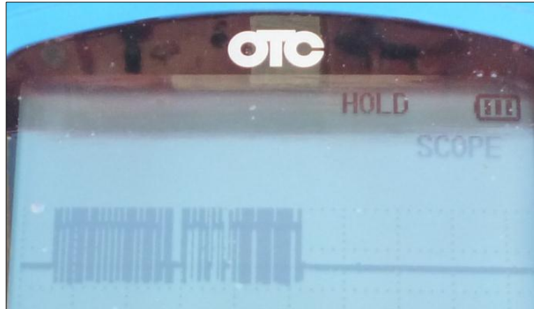
Figura 5.3: Segmento de la señal del protocolo CAN (VP44).
