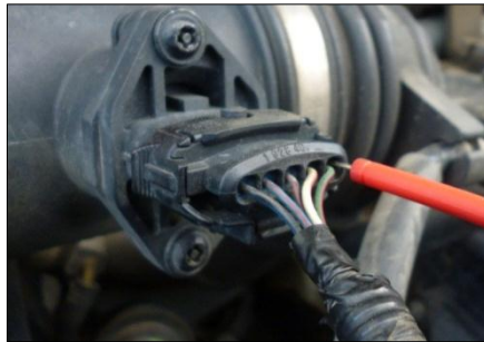
Figura 5.14: Conexión al MAF para prueba de ruta. Fuente: Investigadores.
