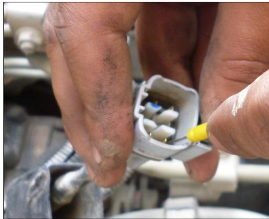
Figura 5.1: Toma de datos del sensor de la cremallera de la bomba TICS Fuente: Investigadores.
