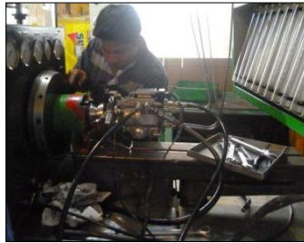
Figura: 10 Montaje bomba de prueba.
