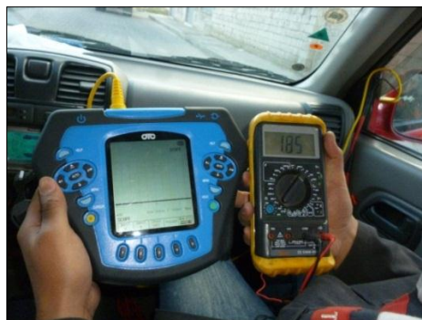
Figura 5.15: Toma de datos en ruta MAF (osciloscopio) y TPS (multímetro). Fuente: Investigadores.
