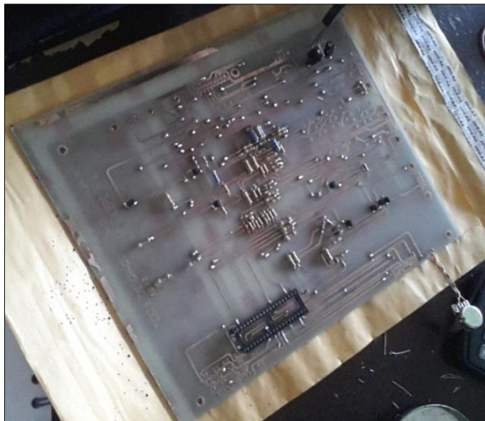
Figura 5.46: Lado de los elementos parcialmente terminado.
