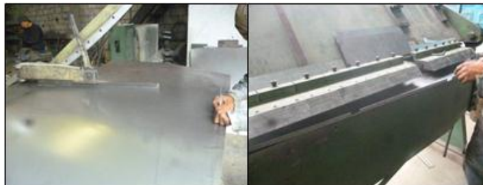
Figura 6.10: Trazado y doblado del tol para el recubrimiento. Fuente: Investigadores.
