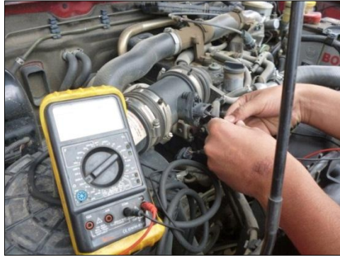
Figura 5.10: Medición de los sensores MAF-IAT.
