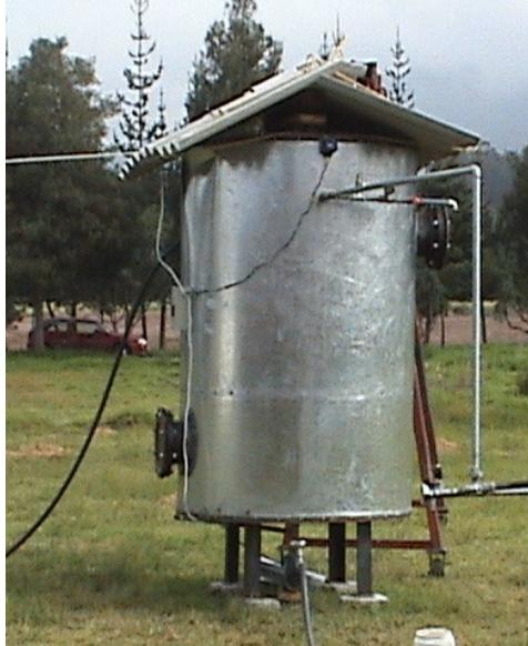
**Figura 2.14** Biorreactor de tipo cilíndrico vertical
