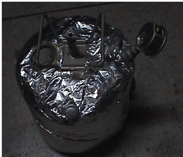
**Figura 6. 37** Envoltura térmica
