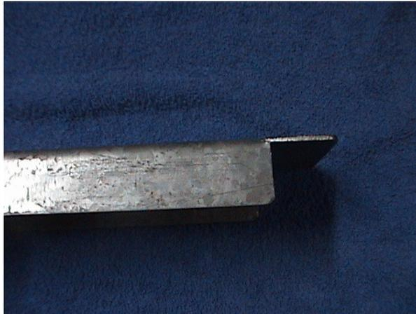
**Figura 5.5** Canal metálico obtenido mediante procesos de doblado a 90°
