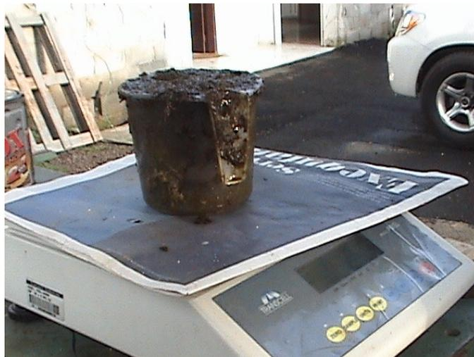
**Figura 6. 35** Pesaje del sustrato en balanza digital
