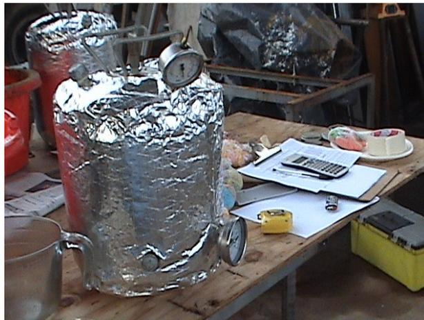
**Figura 6. 27** Recipiente con aislamiento térmico
