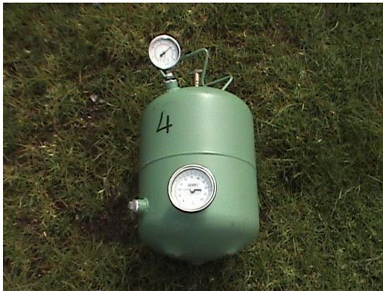
**Figura 6. 22** Instrumentos de medida de presión y temperatura
