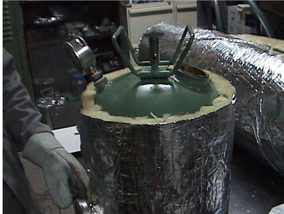
**Figura 6. 26** Colocación de aislamiento térmico
