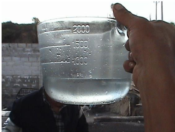
**Figura 6.16** Recipiente de vidrio para medición de volumen de agua
