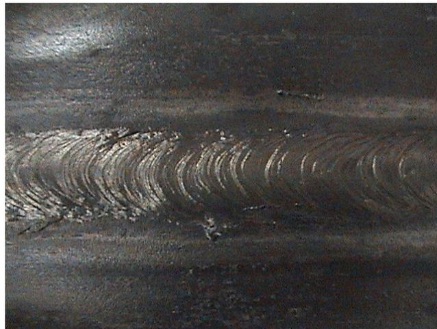
**Figura 5.2** Cordón de soldadura utilizando electrodo E6010
