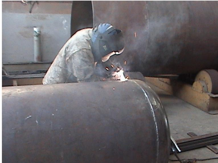
**Figura 5.3** Soldadura de cabezas toriesféricas en un recipiente para soportar presión interna generada por gases como el CH<sub>4</sub>
