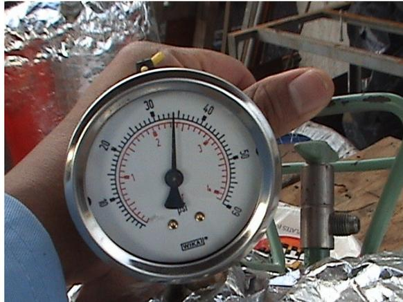
**Figura 6. 18** Manómetro para medir la presión interna del reactor
