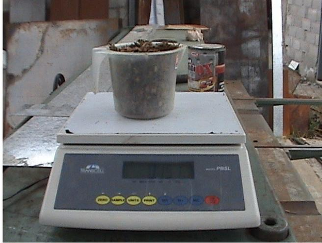
**Figura 6.15** Balanza digital pesando el sustrato
