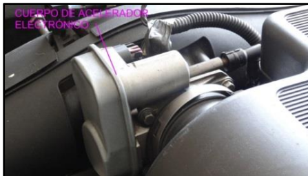
Figura 12. Cuerpo de aceleración electrónico
