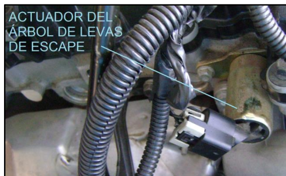
Figura 4.49. Localización del actuador del árbol de levas
