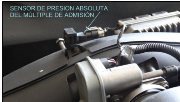
Figura 4.9. Localización del sensor MAP
