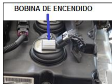
Figura 2.57. Bobinas de encendido
