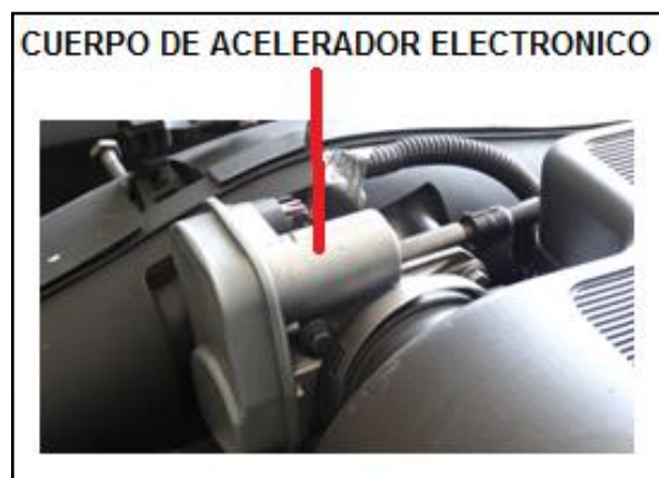
Figura 4.28. Localización del cuerpo de aceleración electrónico
