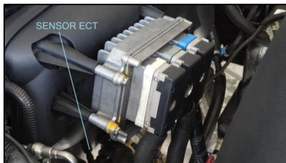
Figura 4.24. Localización del sensor ECT
