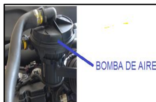
Figura 6. Bomba de aire auxiliar
