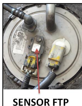
Figura 4.42. Localización del sensor FTP
