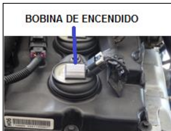
Figura 4.39. Localización de las bobinas de encendido.
