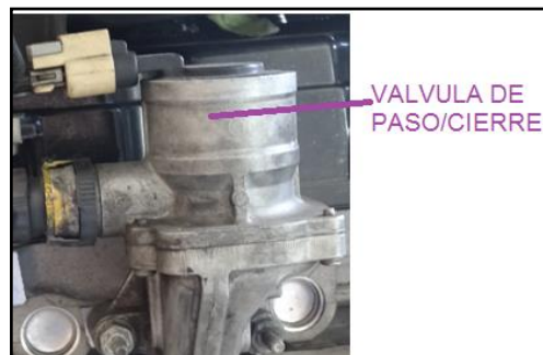
Figura 2.55. Válvula de paso/cierre de aire
