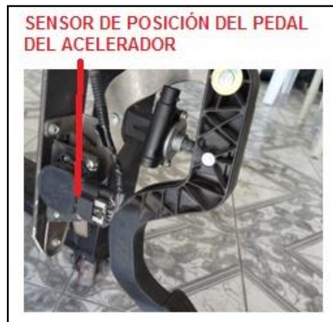
Figura 4.26. Localización del sensor APP
