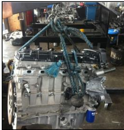
Figura 4.2 Montaje del motor en la estructura
