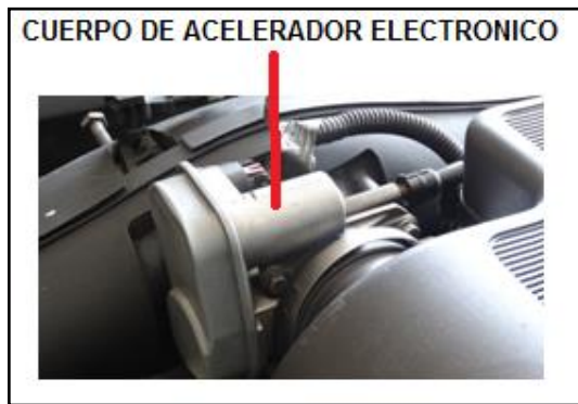
Figura 2.15. Cuerpo de aceleración electrónico
