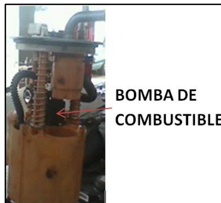
Figura 4.47. Localización de la bomba de combustible
