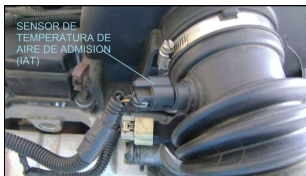
Figura 4.6. Localización del sensor IAT
