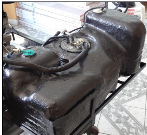
Figura 2.5. Tanque de combustible modificado
