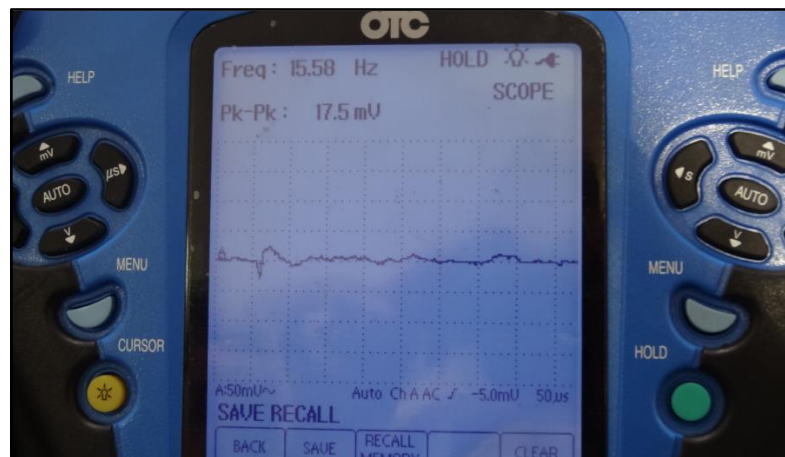
Figura 4.22. Curva del sensor KS
