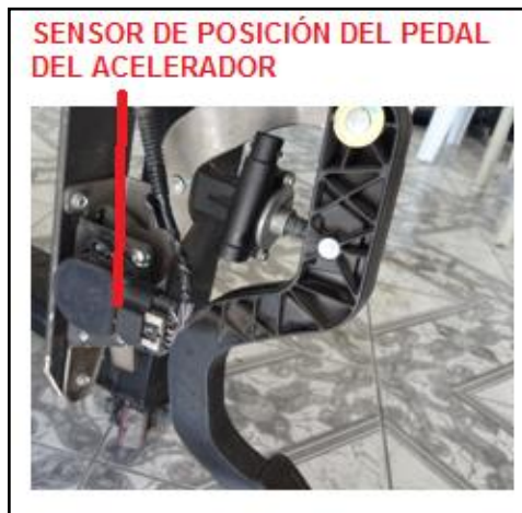
Figura 2.17. Sensor de posición del pedal del acelerador APP
