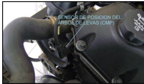
Figura 4.17. Localización del sensor CMP
