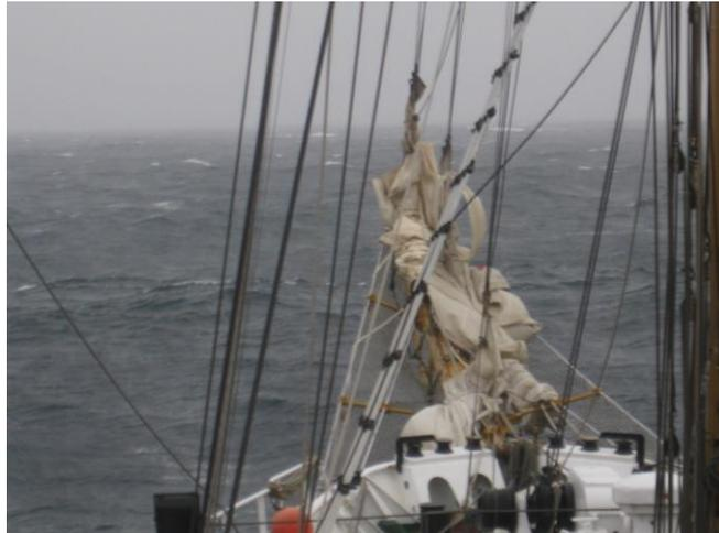
**Figura 3-11, Velas Cuchillas rotas.**
