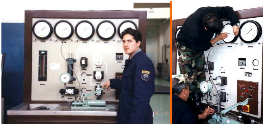
Figura 3.13. Calibración de manómetros
