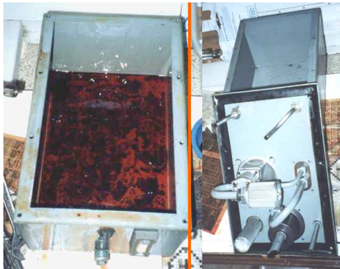
Figura 3.1. Limpieza del reservorio (antes y después)
