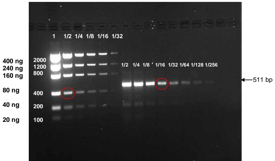
Fig 3.17 Cuantificación de cDNA de dengue virus en un gel de agarosa al 2% teñido con bromuro de etidio. Se muestran las diluciones 1, 1/2, 1/4, 1/8, 1/16 y 1/32 del marcador de peso molecular cuantitativo (low DNA mass ladder), se indica a la izquierda el tamaño de cada fragmento del marcador de peso molecular en pb y su cantidad correspondiente en ng. A la derecha de la foto se visualiza el producto de RT-PCR de 511 bp de diferentes intensidades, se señala las diluciones a las que pertenece cada banda 1/2, 1/4, 1/8, 1/16, 1/32, 1/64, 1/128 y 1/256. El círculo rojo señala las bandas que presentan mayor similitud en intensidad.
