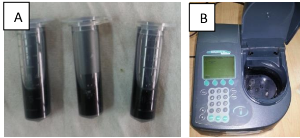
Figura 2.12: Cuantificación de proteínas: A) coloración de proteínas con el reactivo de Lowry-Folin y B) lectura de absorbancia a 500 nm.
