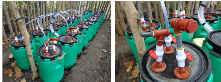
Figura 2.6: Digestores para la elaboración de biol.
