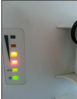
Figura 77. Medidor de la Intensidad de la Señal.
