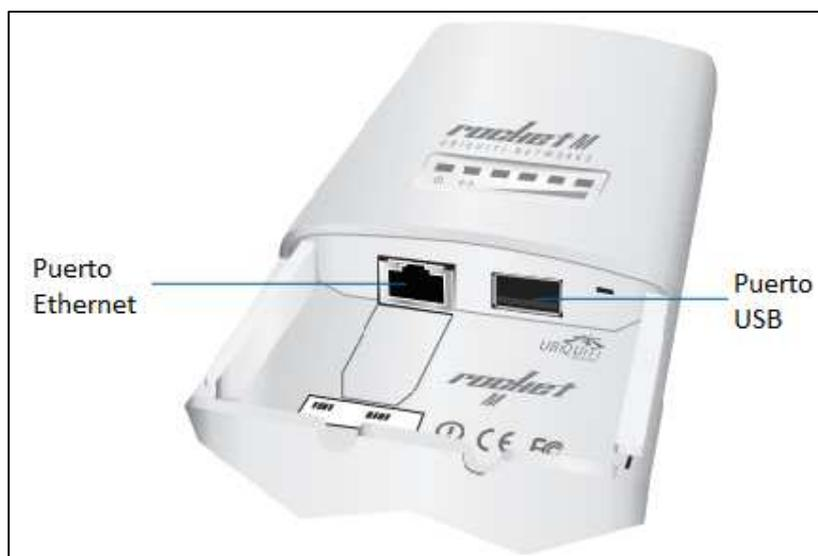
Figura 11. Conectores del Hardware.
