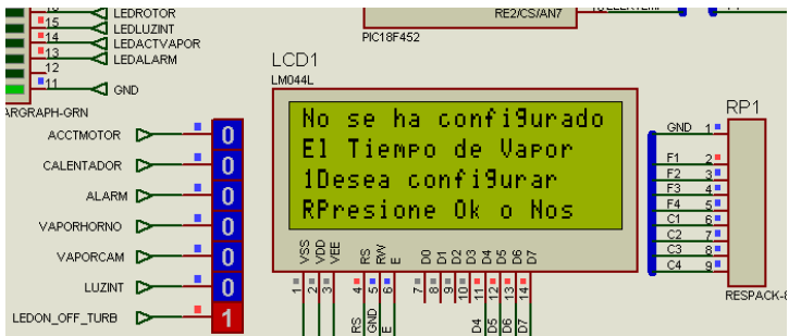
Si no se hubiera programado el vapor y se presionara la tecla de ACTIVAR VAPOR
