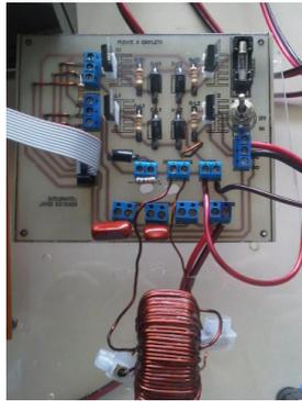
Figura 15. Circuito Convertidor Buck implementado
