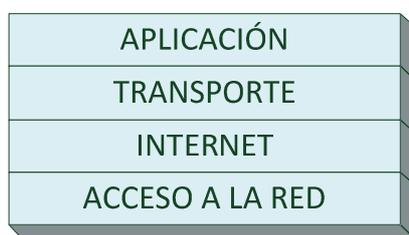
**Figura 5. Arquitectura del modelo TCP/IP**
