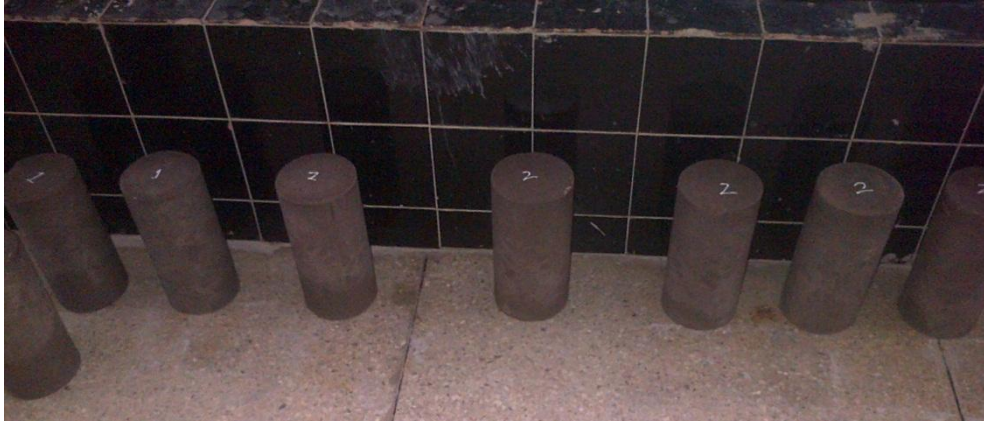
Figura 52: Cilindros de hormigón
