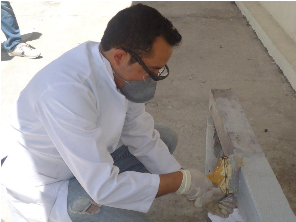
Figura 34: Aplicación de la fibra de vidrio SikaWrap Hex 100G Fuente: Elaborado por: Cevallos, Diego
