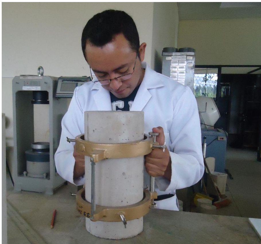
Figura 55: Colocación del compresómetro Fuente: Elaborado por: Cevallos, Diego
