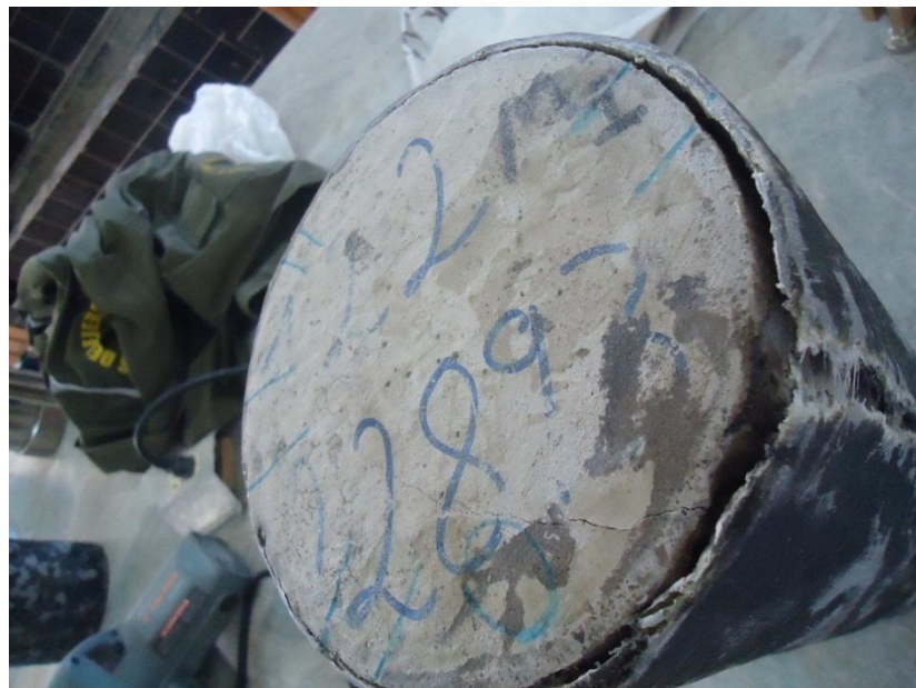
Figura 68: Plano de falla y grietas en hormigón confinado con tres capas de fibra de vidrio tradicional
