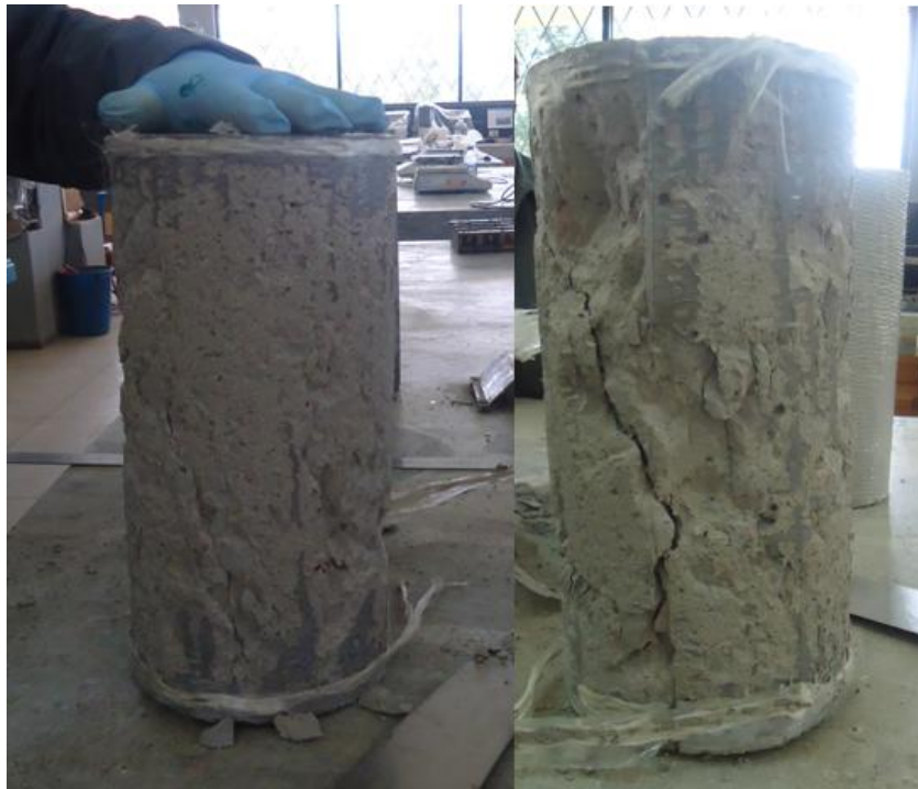
Figura 60: Grietas en hormigón confinado con fibra de vidrio FRP Fuente: Elaborado por: Cevallos, Diego
