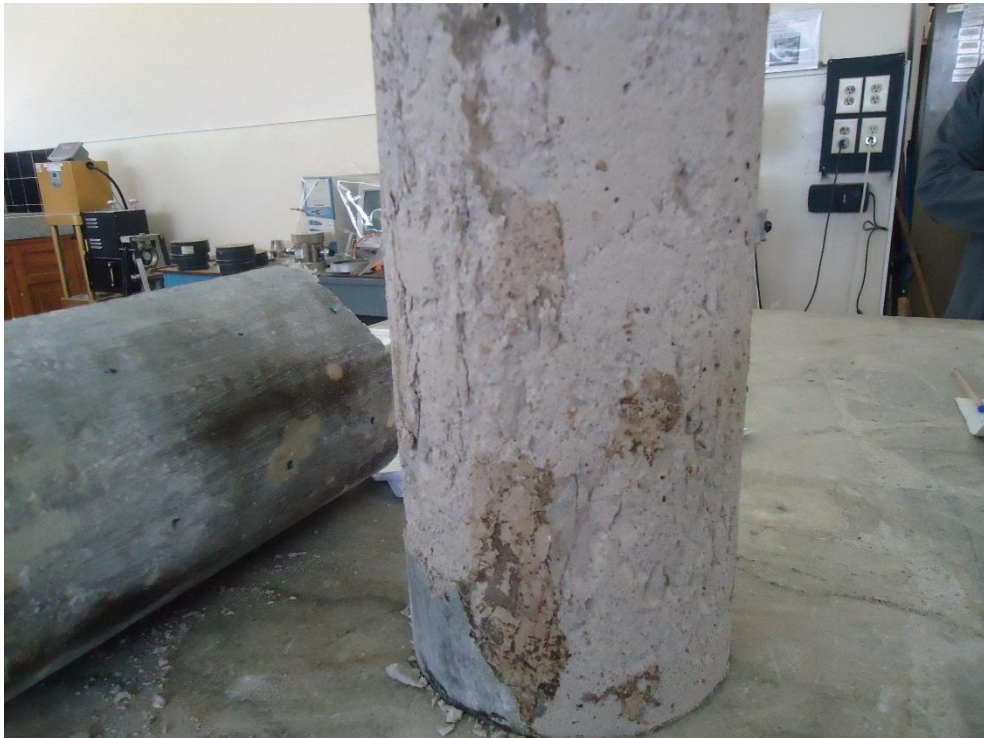
Figura 63: Plano de falla y grietas en hormigón confinado con una capa de fibra de vidrio tradicional
