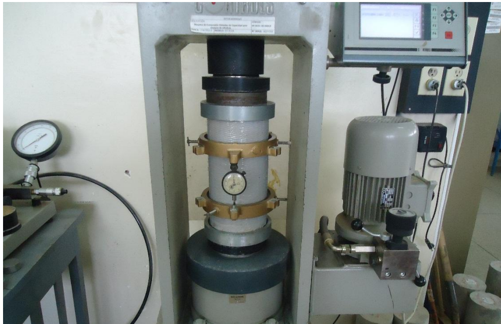
Figura 58: Ensayo curva esfuerzo deformación del hormigón confinado con SikaWrap Hex 100G
