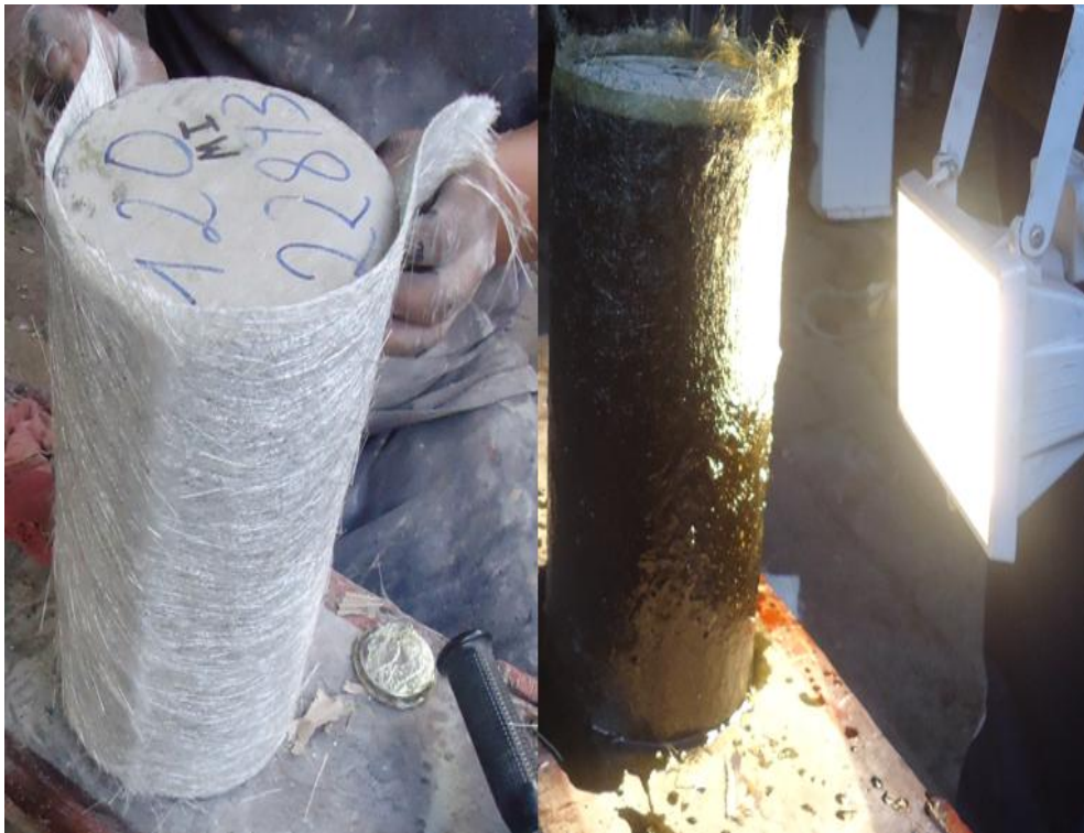
Figura 38: Colocación de la fibra de vidrio, resina y secado. Fuente: Elaborado por: Cevallos, Diego
