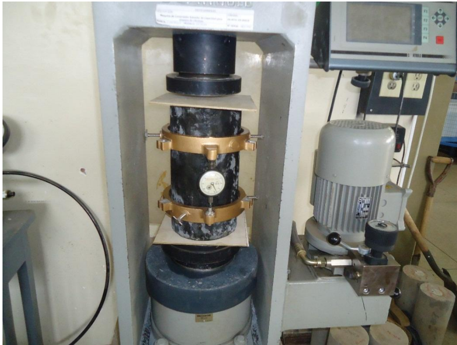
Figura 67: Ensayo curva esfuerzo deformación del hormigón confinado con tres capas de fibra de vidrio tradicional
