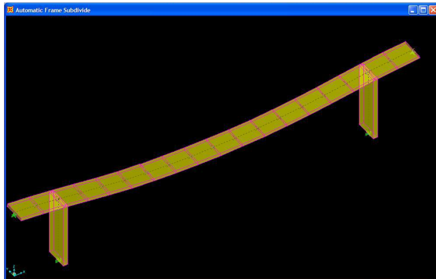
Figura 19: Modelo en SAP del puente La Saquea Fuente: (Rendón & García, 2013)
