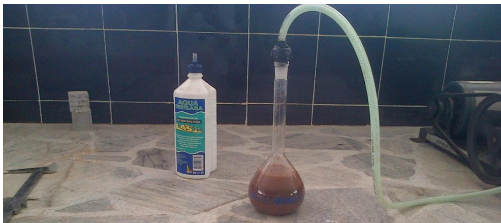
Figura 51: Eliminación de vacíos en el picnómetro
