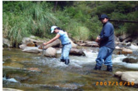
molinete a 0,6 de la profundidad total por debajo de la superficie libre. Para profundidades superiores, generalmente, se mide la velocidad a 0,2 y luego a 0,8 de la profundidad de la superficie libre y se usa el promedio de las dos medidas como la velocidad media en la vertical.
