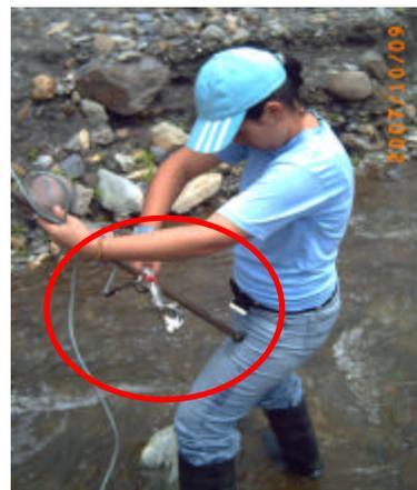
La sección elegida para la medida con el molinete debe estar situada en un tramo recto y de una sección lo más homogénea posible a lo largo de dicho tramo.
