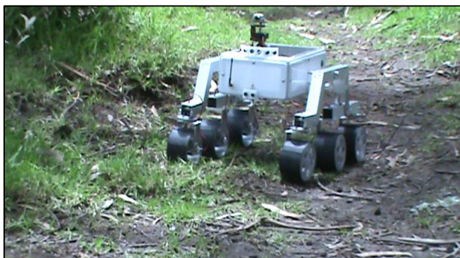
Figura. Nº 159: Pruebas de movilidad del robot en terreno tipo bosque.
