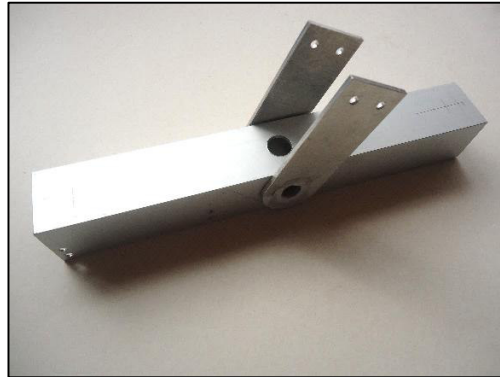
Figura. N° 108: Resultado final de la fabricación del Bogie.
