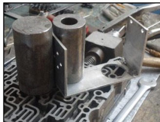
Figura. N° 119: Piezas a unirse mediante soldadura TIG.
