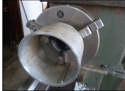
Figura N° 95: Pedazo tubo de aluminio con guía para tapa.
