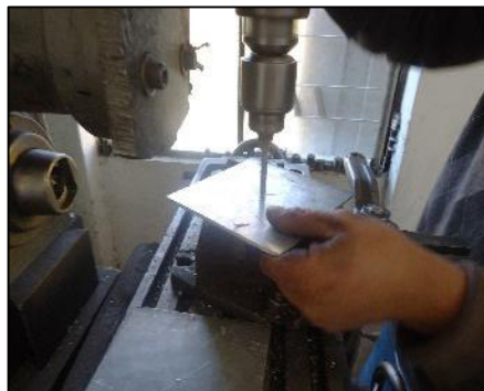
Figura Nº 92: Taladrado de oficios centrales en placas de aluminio.
