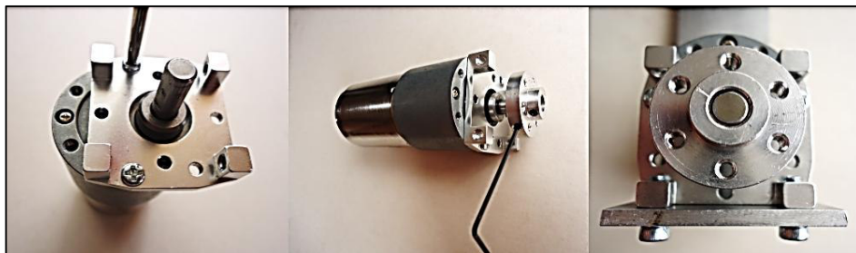
Figura. N° 125: Ensamblaje del acople de las ruedas del robot.
