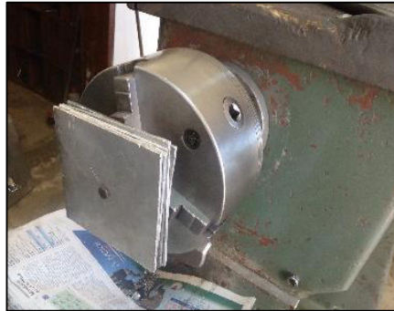
Figura N° 93: Corte de placas de aluminio en torno.
