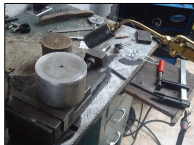
Figura N° 96: Calentamiento de piezas con soplete.
