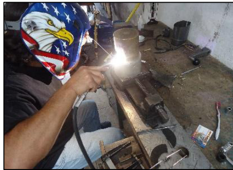
Figura N° 97: Proceso de soldadura de las ruedas de aluminio.
