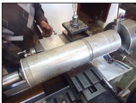
Figura N° 94: Corte del tubo de aluminio en torno.
