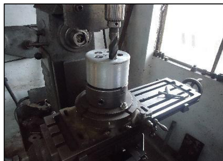
Figura N° 98: Taladrado de orificios en la rueda con fresadora.
