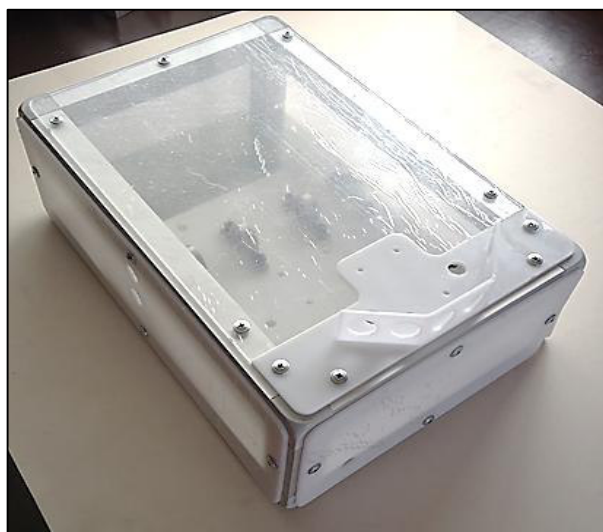
Figura. Nº 124: Resultado final fabricación carrocería del robot.
