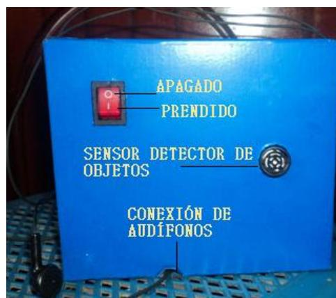
Figura d: Encendido del dispositivo
