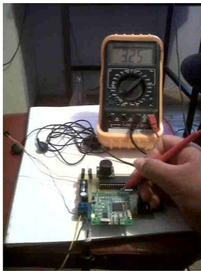
Figura 3. 4: Voltaje medido en el pin RST
