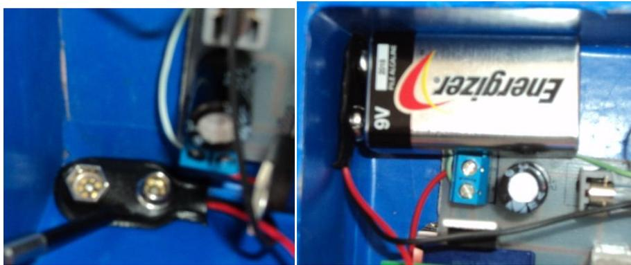
Figura a: Inserción de la batería en el dispositivo
