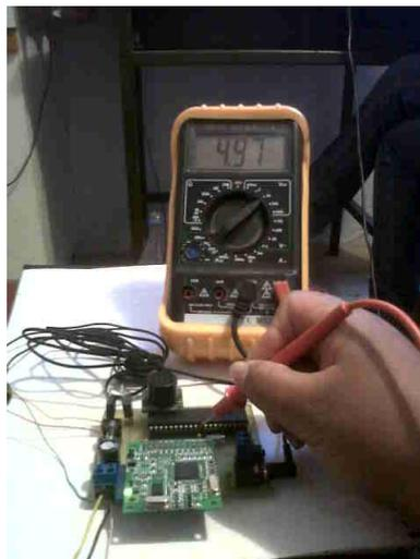
Figura 3. 3: Tensión aplicada al microcontrolador.
