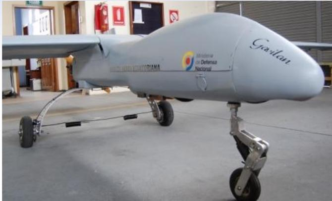
Actualmente se lo ha denominado como UAV-1 Gavilán, es una aeronave de 5.5 m. de longitud de ala, la cual posee capacidades de aterrizaje, despegue y vuelo automático, puede alcanzar 15 000 pies de altura y 140 km/h. Posee transmisión en tiempo real a través de una cámara de video con un sistema electroóptico.
