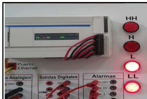
**Figura 3.10: Luces de alarmas del sistema SCADA<sup>169</sup>**
