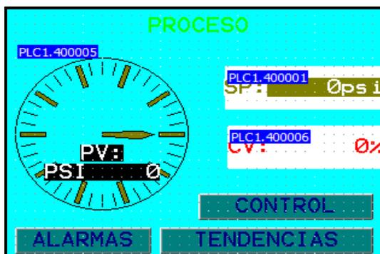
Figura 2.28: Página de Proceso del HMI local de Presión<sup>124</sup>
