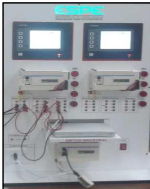
Figura 3.2: Armario de control del sistema SCADA<sup>161</sup>
