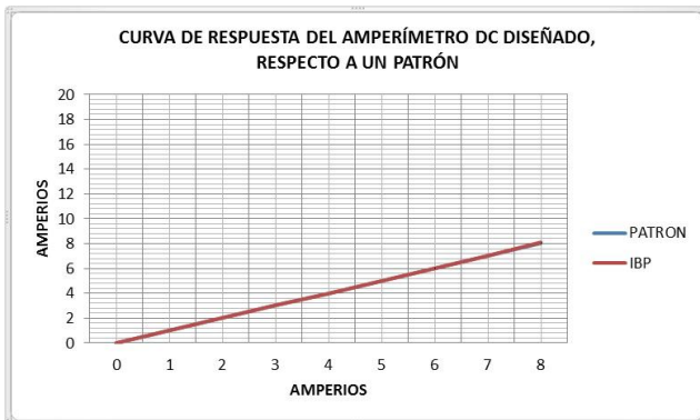
Fig. 24 Curva de respuesta del amperímetro DC diseñado, respecto a un patrón.
