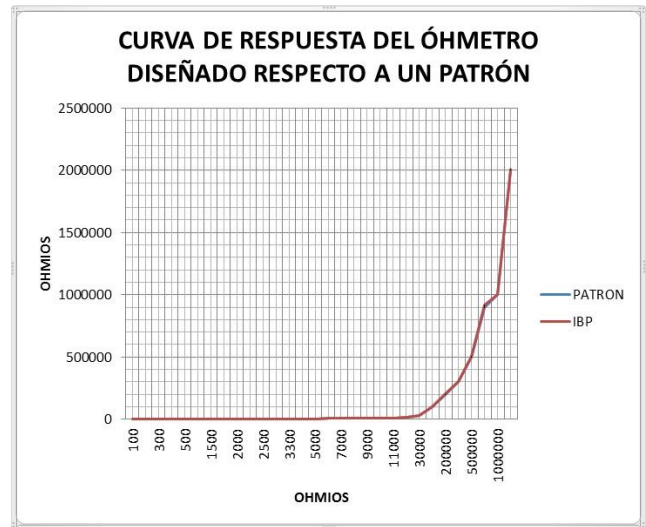
Fig. 25 Curva de respuesta del óhmetro diseñado respecto a un patrón
