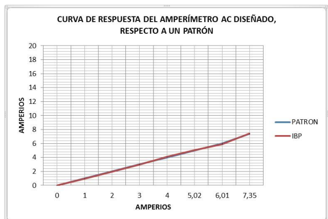
Fig. 23 Curva de respuesta del amperímetro AC diseñado, respecto a un patrón.
