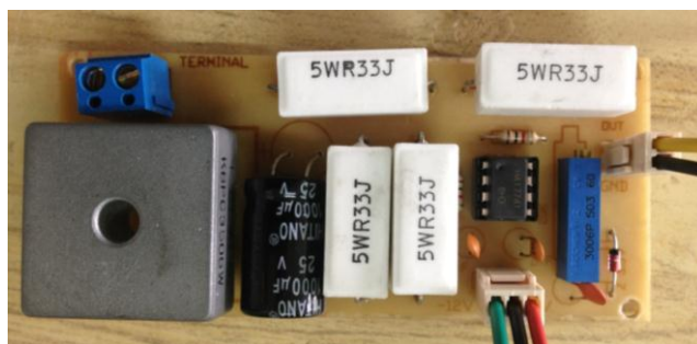
Fig. 11 Placa final del acondicionamiento de la señal de corriente alterna
