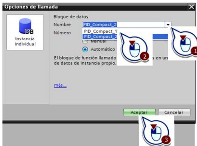
Figura 2.35: Confirmación del PID_Compact_1.
