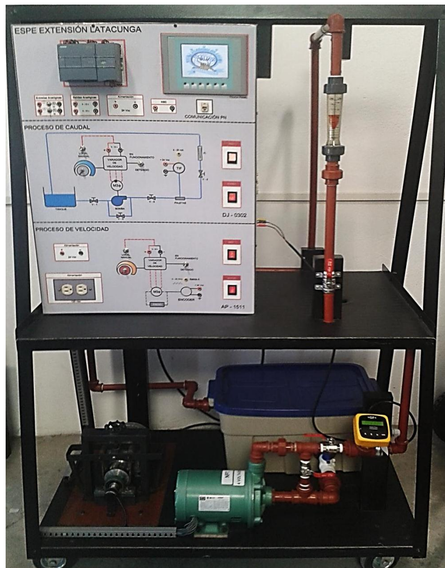
Figura 3.1: Módulo didáctico de los procesos caudal y velocidad.
