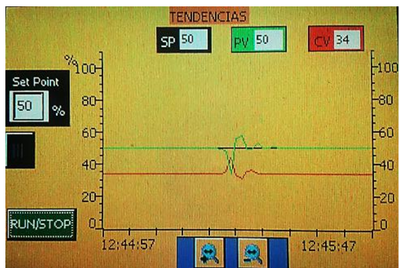
Figura 3.46: Curva de respuesta del control proporcional integral derivativo ante una perturbación del proceso velocidad.
