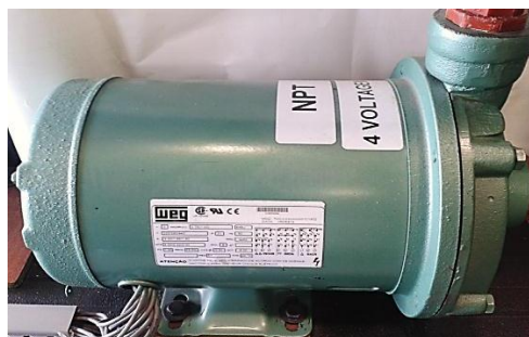
Figura 3.4: Bomba trifásica de 1HP.
