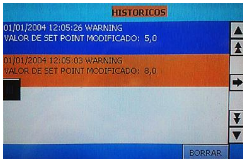
Figura 3.51: Cambio del valor de set point del proceso caudal.
