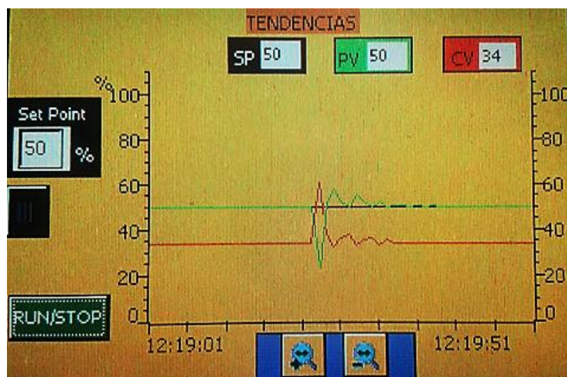
Figura 3.42: Curva de respuesta del control proporcional integral ante una perturbación del proceso velocidad.
