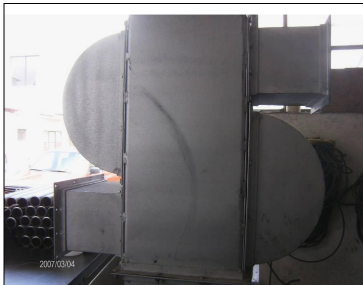
Figura 5.3. Intercambiador de Calor
