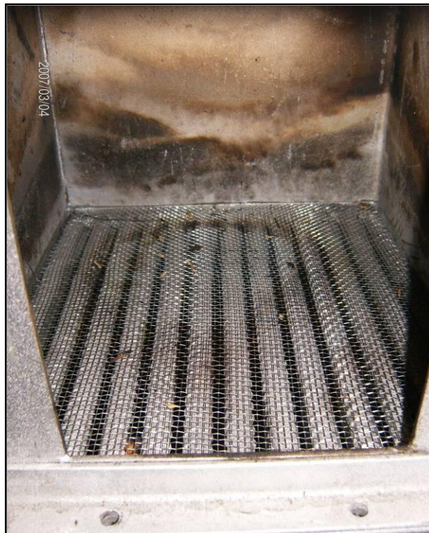
Figura 5.2. Cámara de combustión
