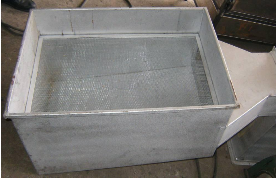
Figura 5.6. Cámara de secado
