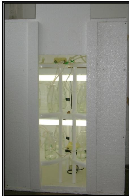
Figura 2.1 Cámara de crecimiento de *Anabaena* sp. donde se controla la temperatura, luz 12:12h y aireación (1cm=12.20cm).
