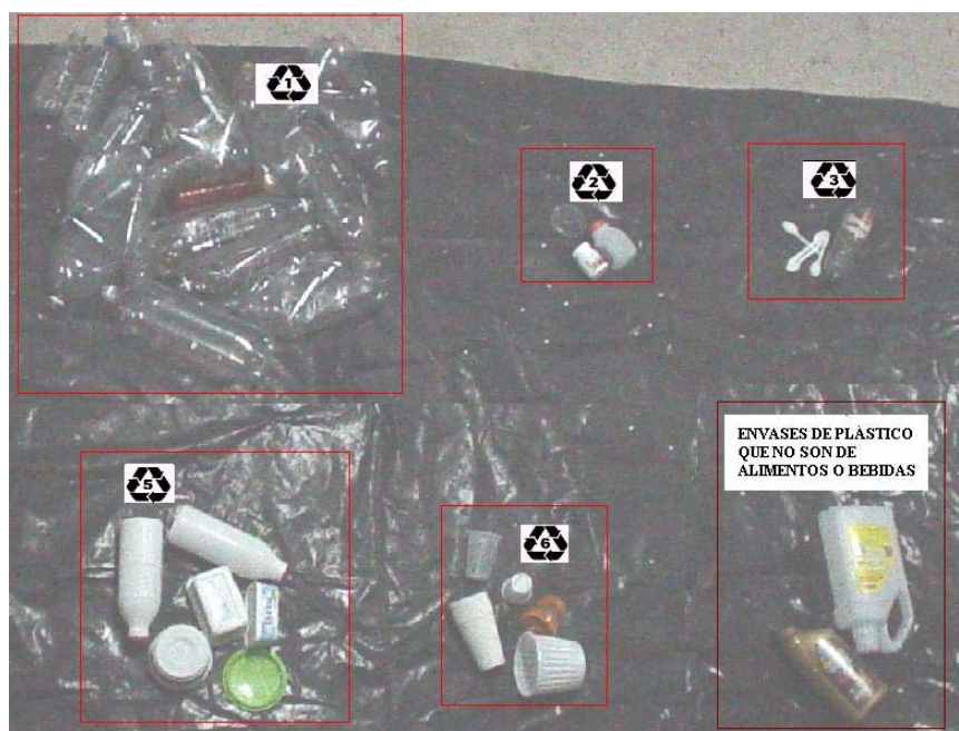
Figura. 7.20. Clasificación de los Residuos Plásticos producidos en un día del cantón Rumiñahui
