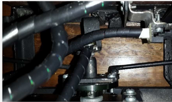
Figura 98 Organización del cableado mediante espiral 1
