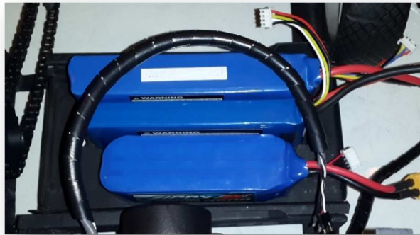
Figura 86 Soportes para las baterías
