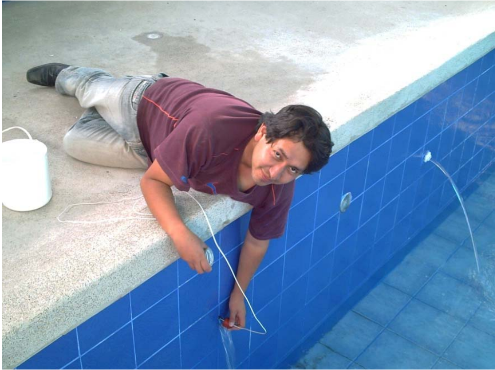
Foto15. Medición de la temperatura de salidas entregadas por los colectores solares (Sr Curicama).
