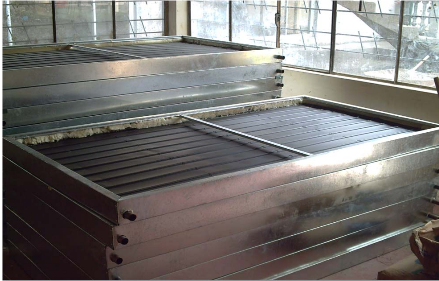
Figura 6.5.2 Colectores solares terminados.
