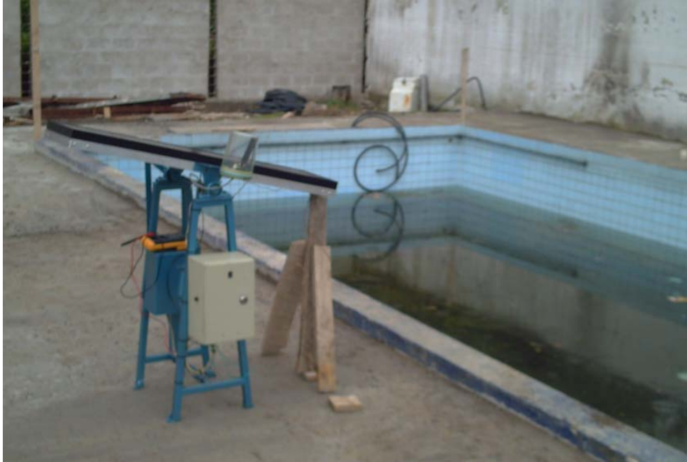
Foto1. Celda fotovoltaica para medir la radiación solar
