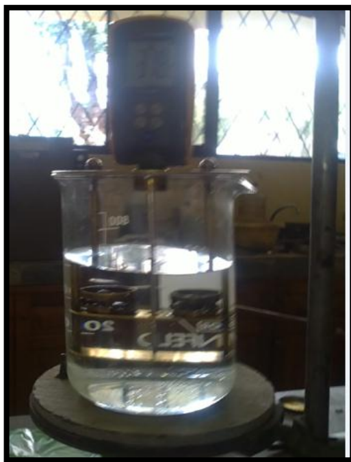
Figura 16: Conjunto del baño para ensayo de Punto de Reblandecimiento.
