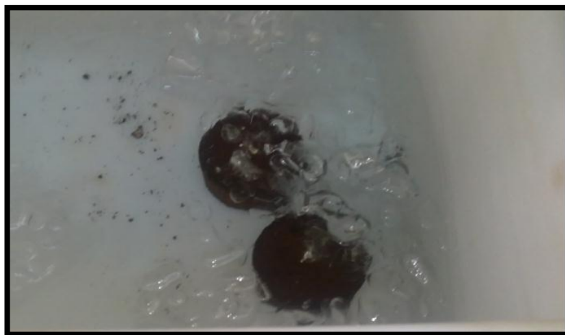
Figura 41: Briquetas sumergidas en agua a 0°C.
