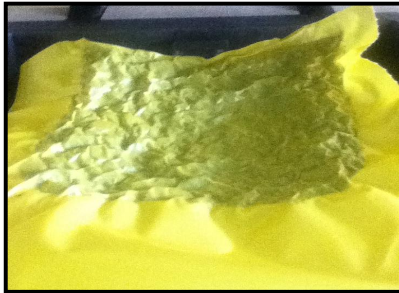
Figura 38: Funda con mezcla sometida a extracción de vacíos.
