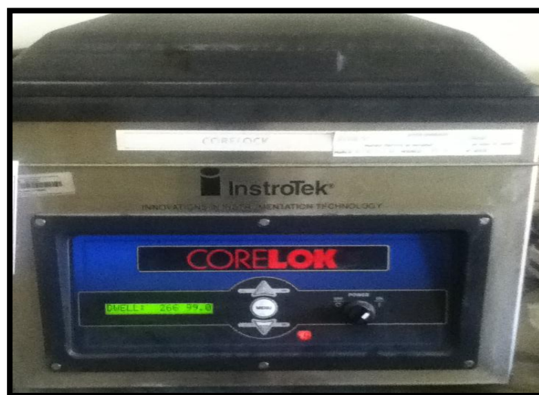
Figura 37: Equipo para ensayo RICE.
