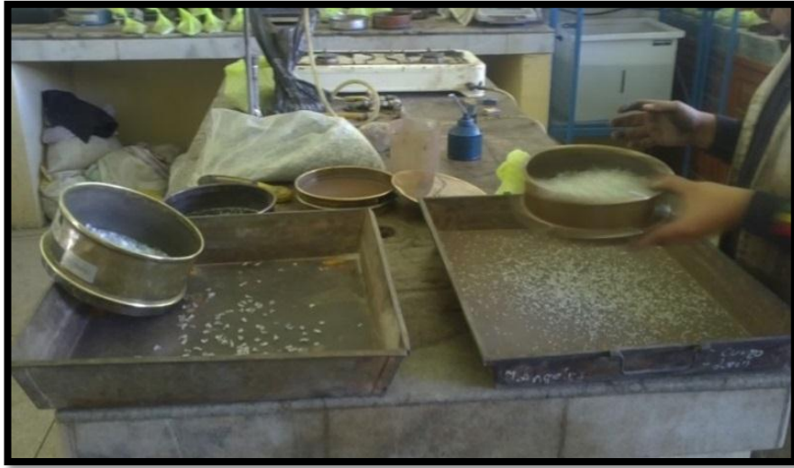
Figura 33: PET Tipo 1 tamizado.
