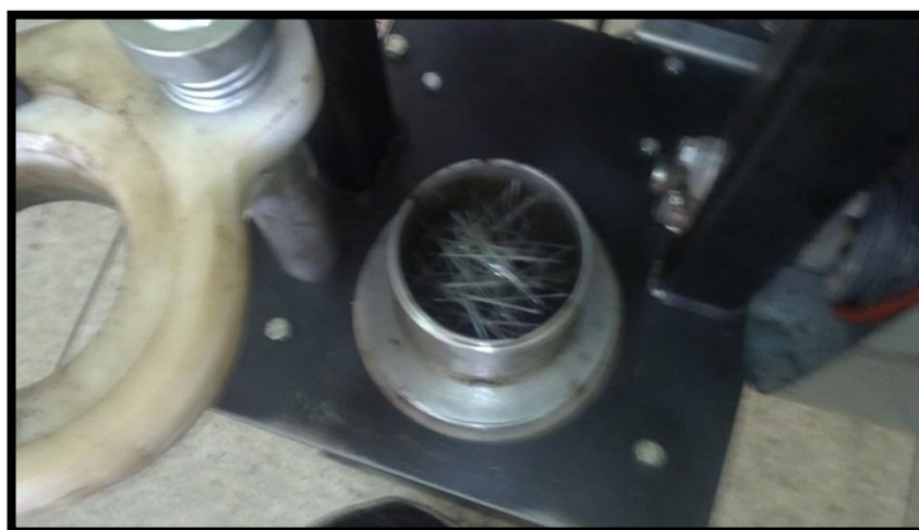
Figura 27: PET Tipo 1 dispuesto en Fibra colocado en molde junto con muestra.
