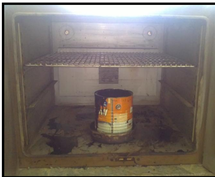
Figura 19: Calentamiento de muestra de Asfalto.
