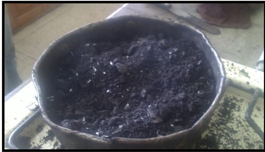
Figura 35: PET Tipo 1 pasante del tamiz #10 o retenido en el tamiz #40 añadido a mezcla.
