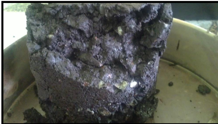
Figura 32: PET Tipo 1 en briqueta luego de ensayada.
