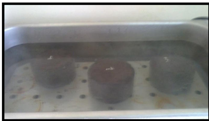
Figura 25: Probetas en baño maría a 25°C.
