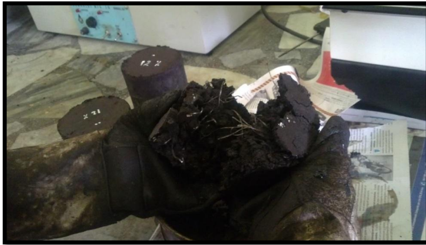
Figura 28: PET Tipo 1 dispuesto en Fibra luego de ensayada la Briqueta.
