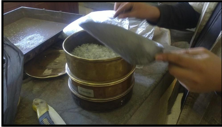
Figura 29: tamizado de PET Tipo 1 triturado.
