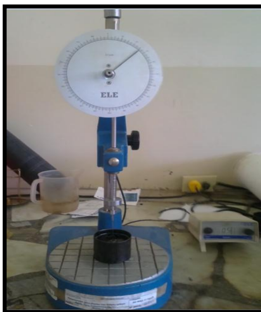
Figura 22: Ejecución y finalización del ensayo de Penetración
