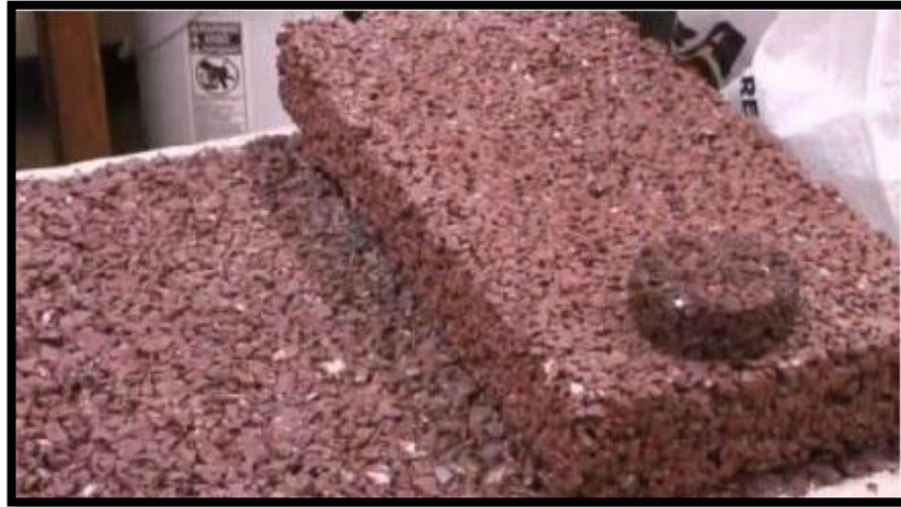
Figura 1: Probetas de Plastisoil hechas en laboratorio.
