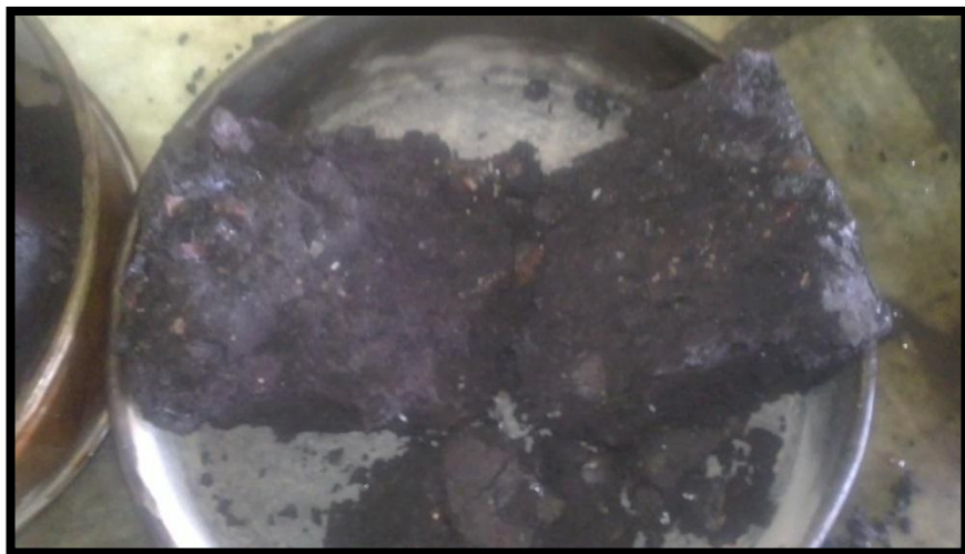
Figura 36: PET Tipo 1 en briqueta ensayada.
