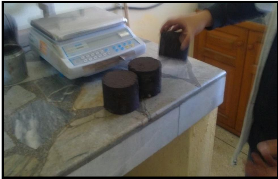
Figura 24: Probetas secas sacadas de moldes.
