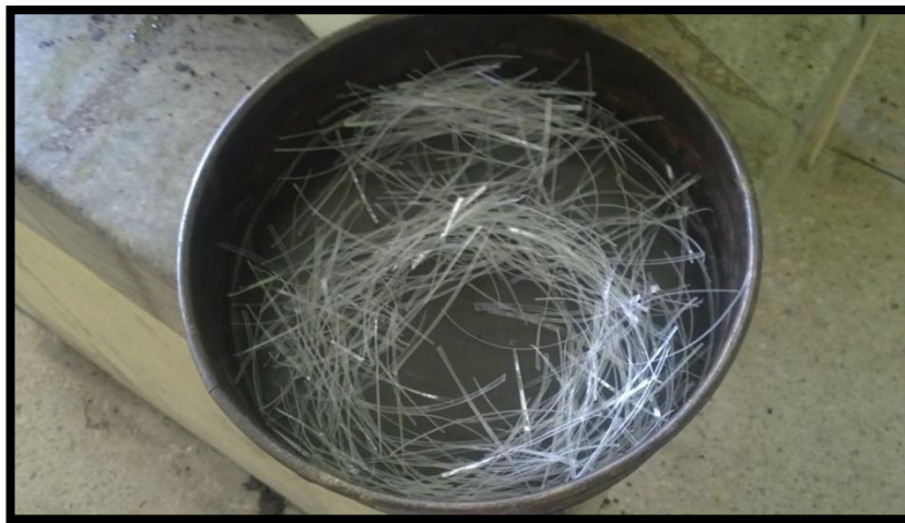
Figura 26: PET Tipo 1 dispuesto en Fibra.
