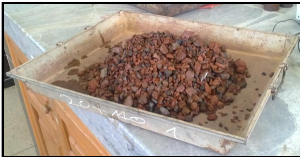
Figura 8: Agregado grueso lavado.
