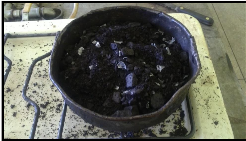
Figura 31: PET Tipo 1 añadido en mezcla.
