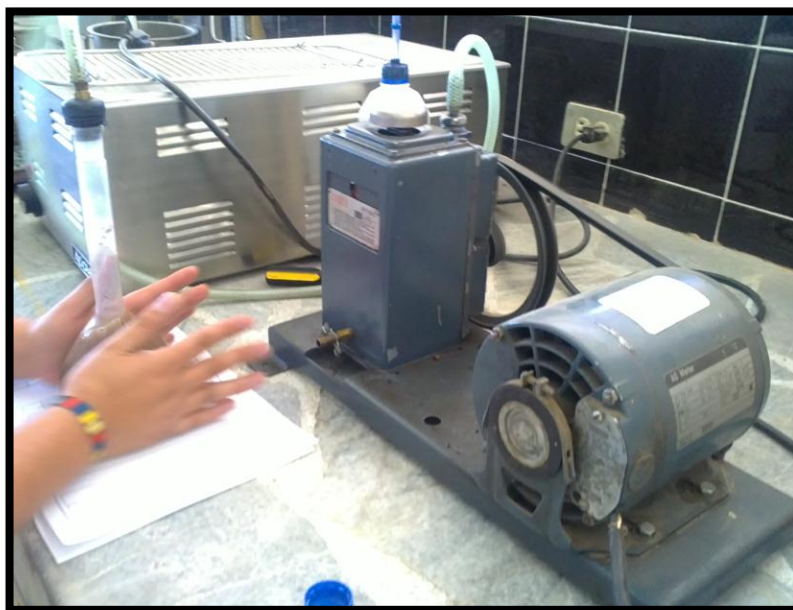
Figura 9: Bomba de Vacío.
