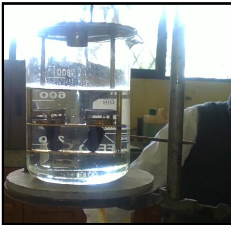
Figura 17: Finalización ensayo Punto de Reblandecimiento.
