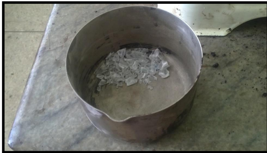
Figura 30: PET Tipo 1 retenido en tamiz #4 o pasante del tamiz #3/8.
