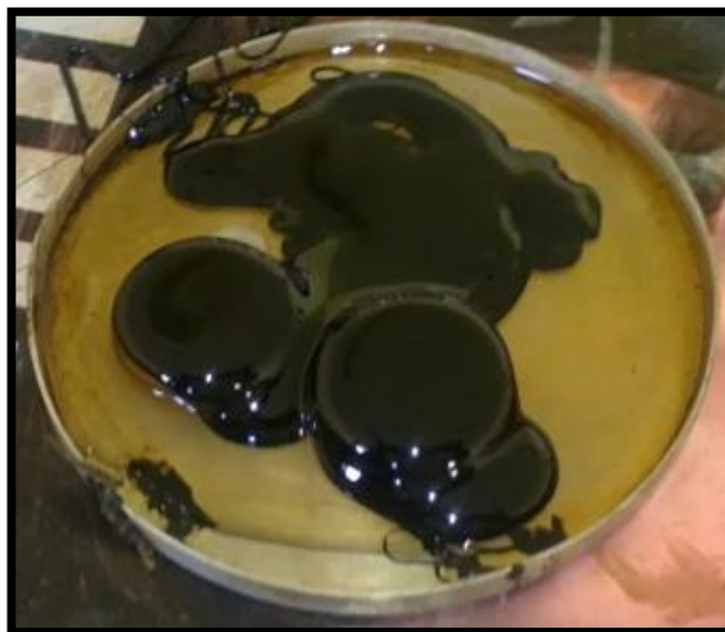
Figura 15: Anillos llenados con asfalto
