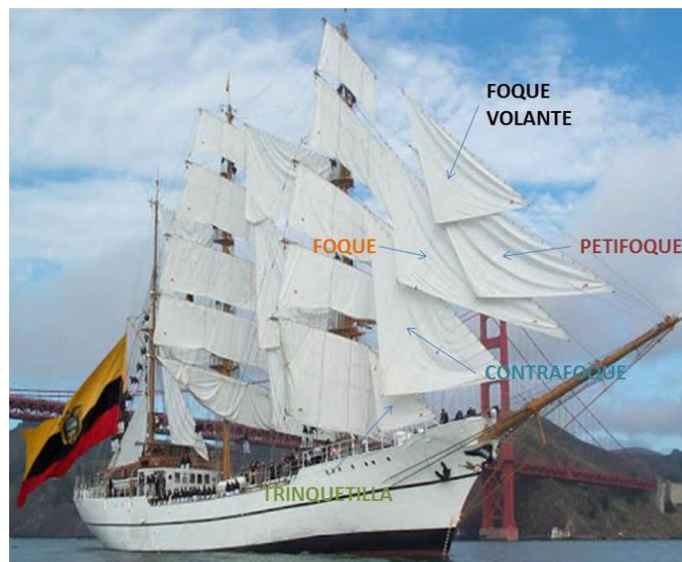
Figura 1-1 Velas del Palo Bauprés
