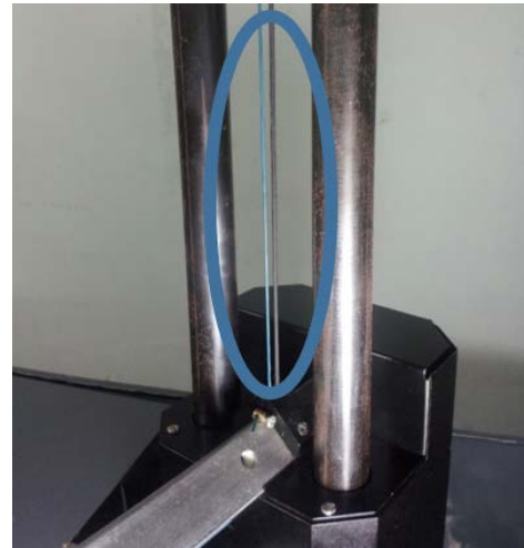
FIGURA 4. REHABILITACIÓN DE LA ARTICULACIÓN PRISMÁTICA DEL EJE Z.
