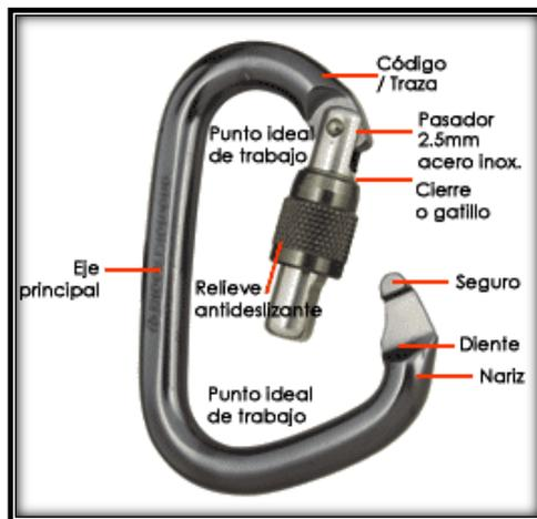
Figura 8 PARTES DE UN MOSQUETÓN
