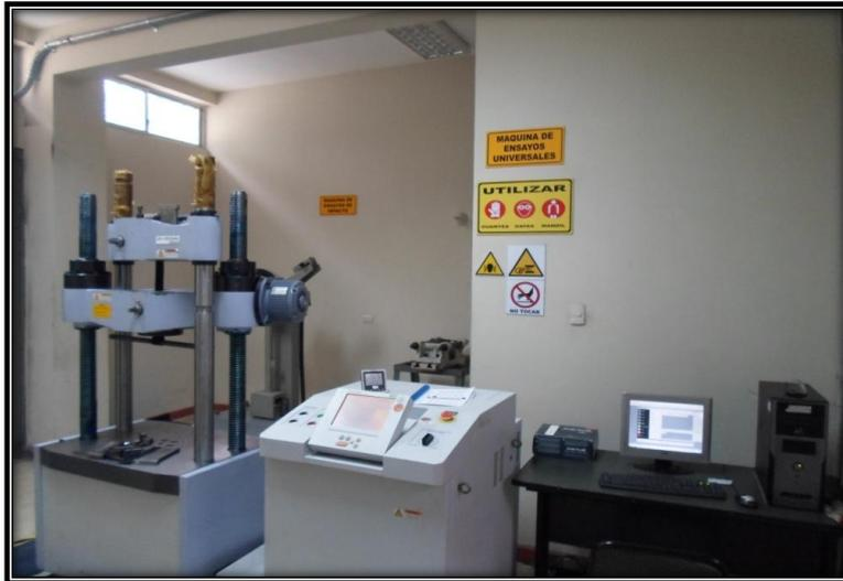
Figura 10 MAQUINA DE ENSAYOS UNIVERSALES
