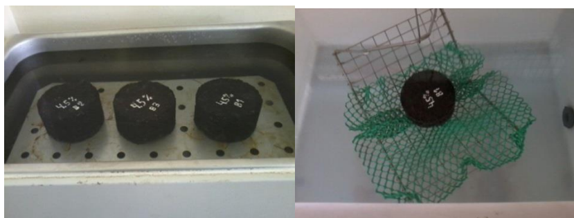
Figura. 85: A la izquierda las briquetas sumergidas a t=25^{\circ}\text{C} y a la derecha sumergida en canasta de balanza de inmersión.
