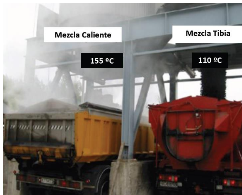
Figura. 13: Comparación de la descarga de mezcla en la planta de asfalto en donde a la izquierda se tiene una mezcla en caliente y a la derecha una mezcla tibia.
