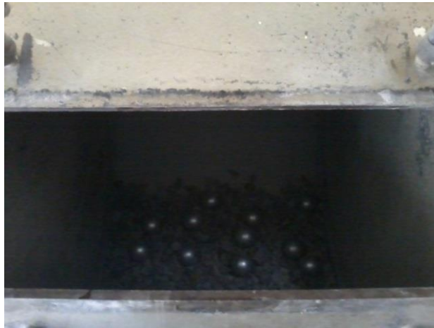
Figura. 61: Muestra puesta en la máquina con 11 esferas de carga abrasiva
