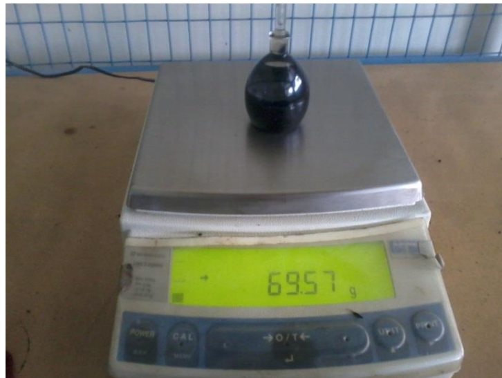
Figura. 49: Registro del peso “D”, picnómetro +agua destilada +asfalto a 25°C.
