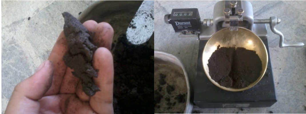
Figura. 68: A la izquierda se observa el procedimiento para límite plástico y a la derecha el ensayo para límite plástico.
