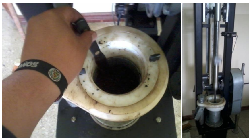
Figura. 79: A la izquierda se muestra la consolidación de la mezcla y a la derecha el procedimiento de compactación.
