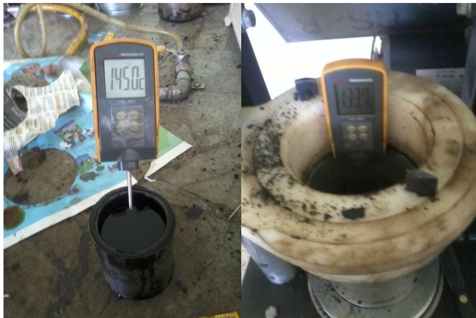
Figura. 84: Para la mezcla con ACP al 2%, en la fotografía de la izquierda se evidencia la temperatura de mezcla de 145 °C y de compactación a la derecha de 133.7°C.
