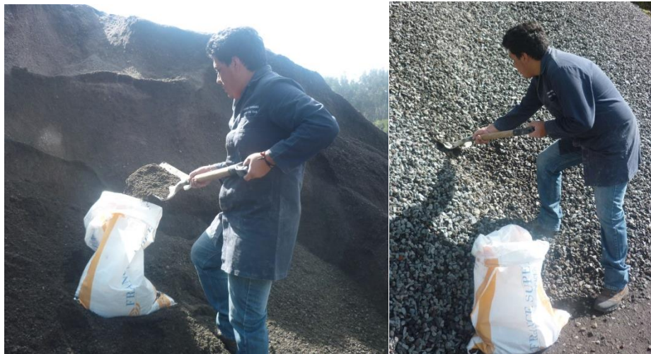
Figura. 60: A la izquierda se presenta el muestreo del agregado fino y a la derecha del agregado grueso
