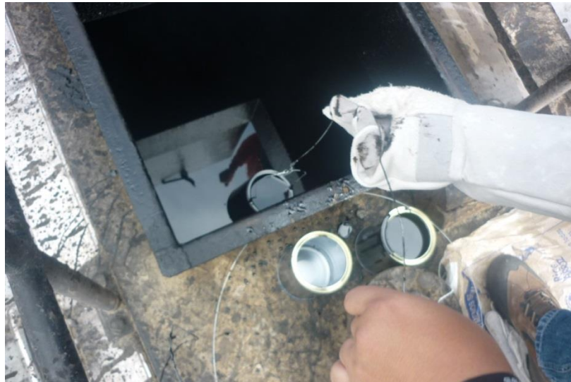
Figura. 37: Toma de muestras de asfalto
