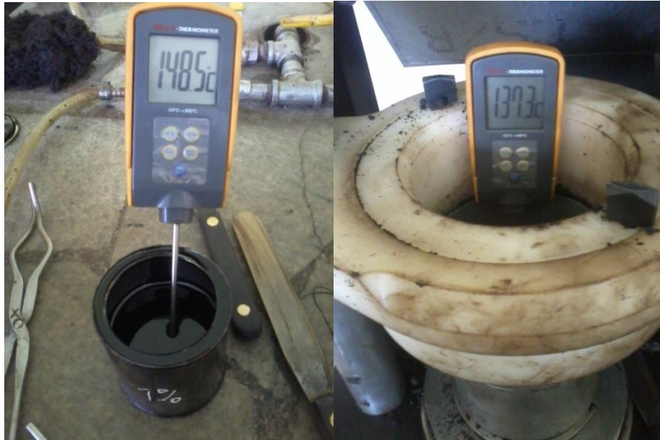
Figura. 83: Para la mezcla con ACP al 1% en la fotografía de la izquierda se evidencia la temperatura de mezcla del asfalto a 148.5 °C y de compactación a la derecha de 137.3 °C.
