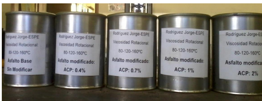
Figura. 57: Envases con los asfaltos modificados con ACP en los porcentajes definidos.
