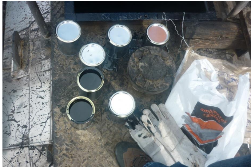
Figura. 38: Muestras de asfalto tomadas del tanque de almacenamiento
