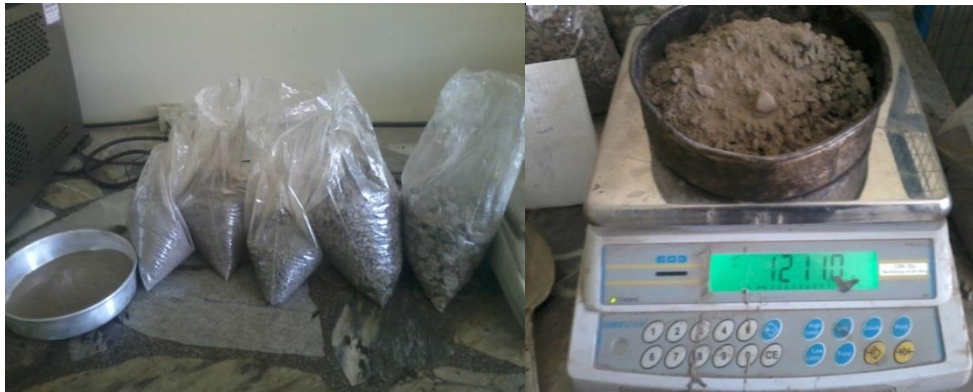
Figura. 78: A la izquierda se muestra los agregados separados por tamaños y a la izquierda ya unidos según la granulometría estabilizada.
