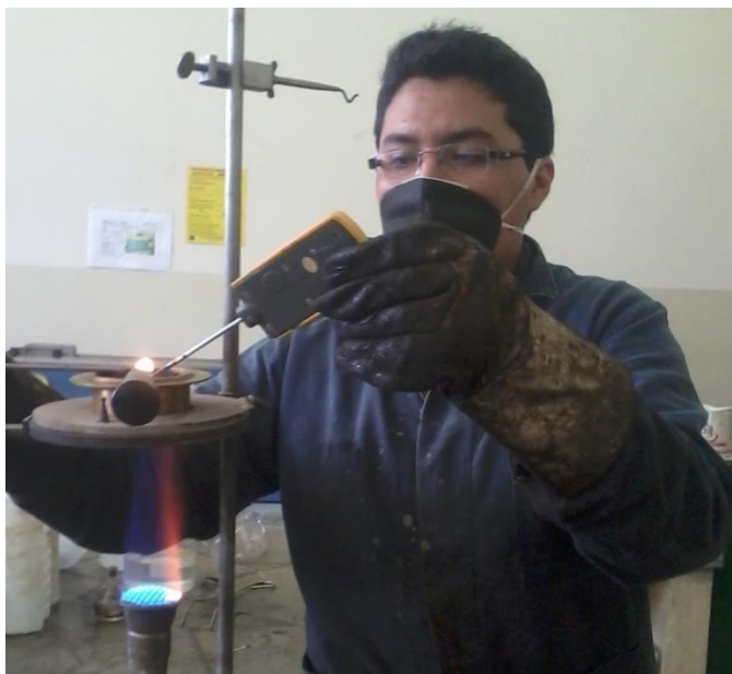
Figura. 48: Combustión del asfalto en el ensayo
