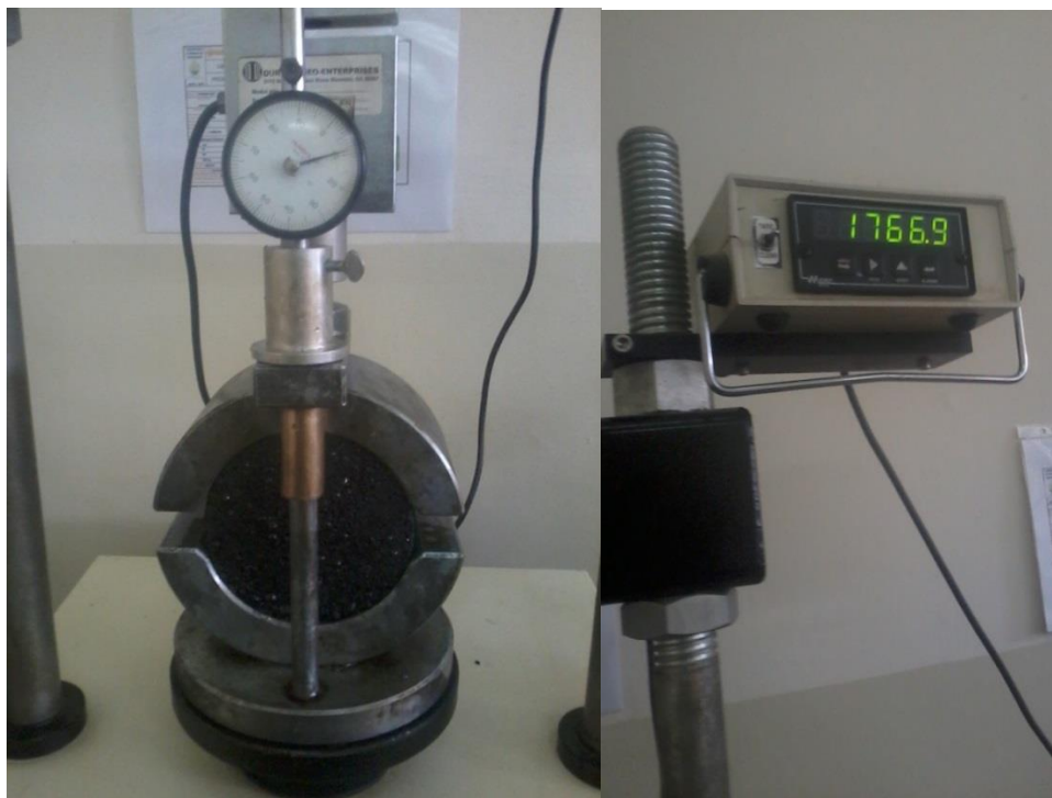
Figura. 86: En la izquierda se muestra la briqueta y su valor de flujo y a la derecha la estabilidad en Kg.
