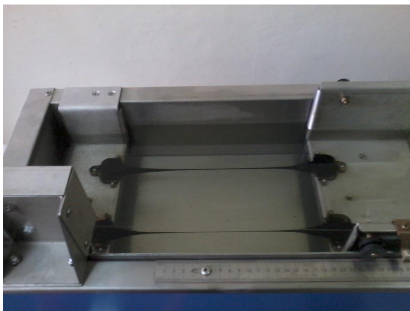
Figura. 44: Ejecución del ensayo de ductilidad
