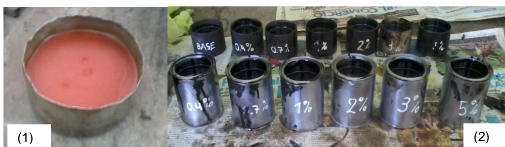
Figura. 41: (1) ACP para la mezcla, (2) envases con Asfalto+ACP con los diferentes porcentajes utilizados.
