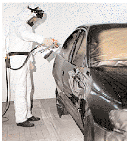
Figura 2.19 Aplicación de pintura dentro de una cabina
