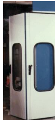
Figura 2.13 Detalles de las Puertas Abatibles de una Cabina-Horno
