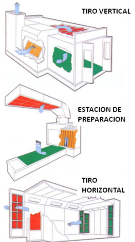
Figura 2.31 Ubicación de filtros en la cabina
