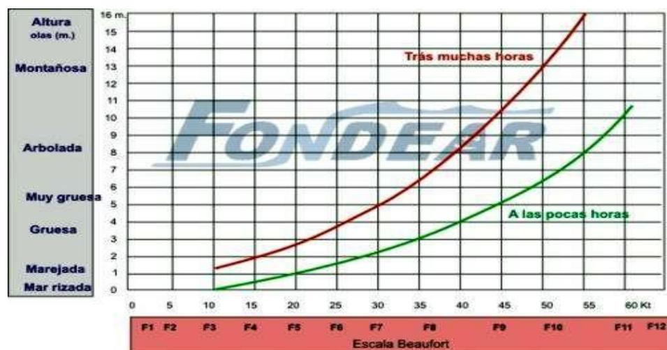
Figura 2-8. Altura de las olas en función de la velocidad del viento
