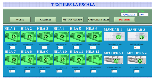
Fig. 9. Pantalla principal del HMI, en la cual se observan el estado de las hilas y los botones de multifunción.
