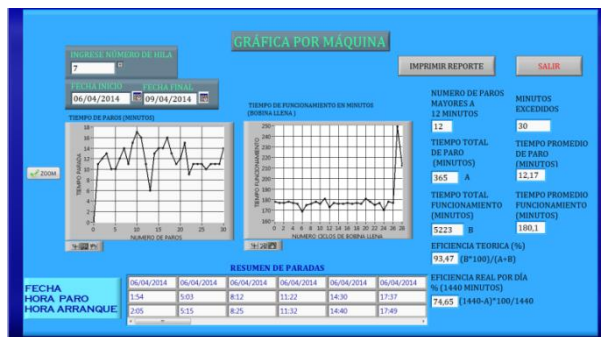
Fig. 14. En la ventana de máquina se observa toda la información requerida por el personal, además de mostrar los tiempos entre las dos fechas ingresadas.
