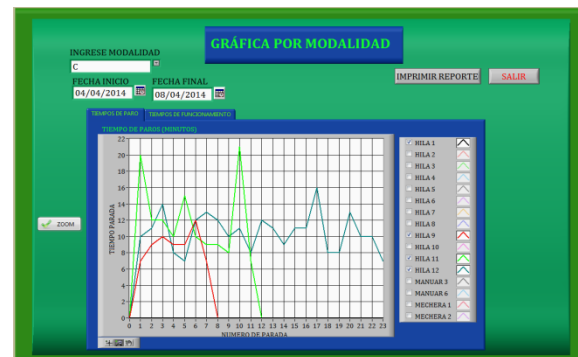
Fig. 13. En la ventana de modalidad se observa dos graficas las cuales muestran el tiempo deparadas producidas y los tiempos de funcionamiento.
